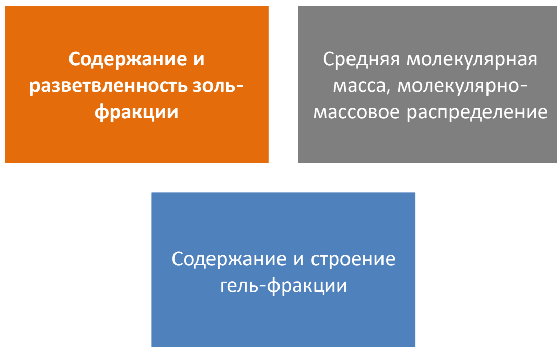
Рисунок 3 – Важнейшие молекулярные параметры каучука СКИ-3
