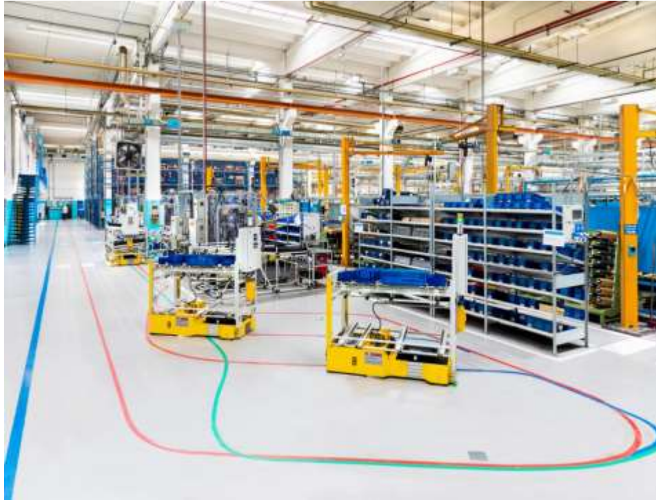
Рисунок 10 - Наглядный вид перемещения груза с помощью AGV по магнитной ленте
