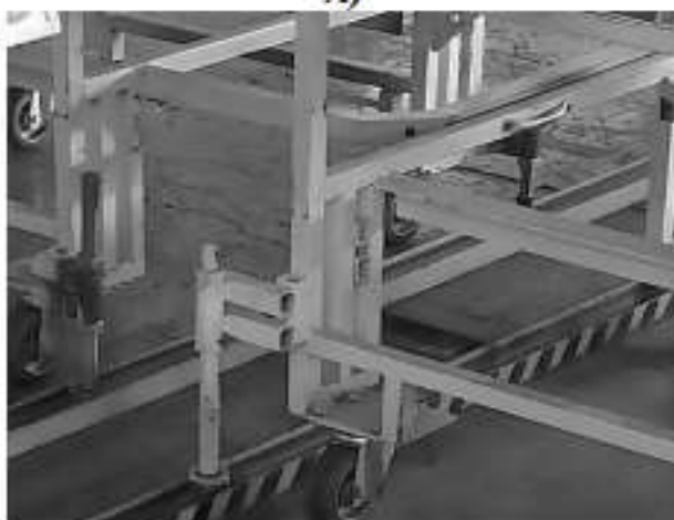
Рисунок 5. Стыковка и передвижение тележки с грузонесущей подвеской конвейера: А) сверху, Б) снизу
