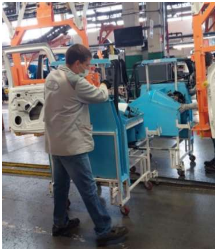
Рисунок 73 - Момент стыковки тележки с подвеской грузонесущего конвейера
