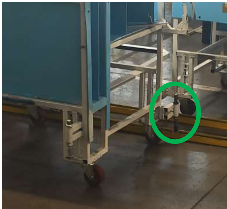
Рисунок 34 - Зафиксированные оси, координирующие и поддерживающие телегу на линии сборки дверей
