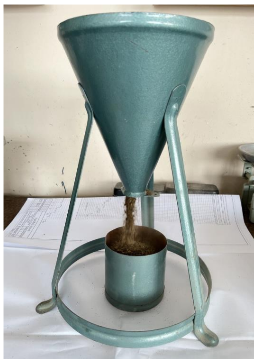
Рисунок 15 - Определение насыпной плотности Волжского песка
