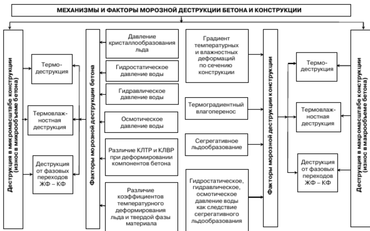
Рисунок 6 – Механизмы и факторы морозной деструкции бетона
