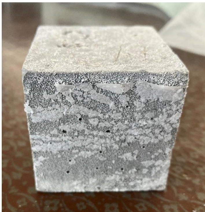
Рисунок 30 – Образец, подверженный агрессивному воздействию MgCl_2 в течении 90 суток
