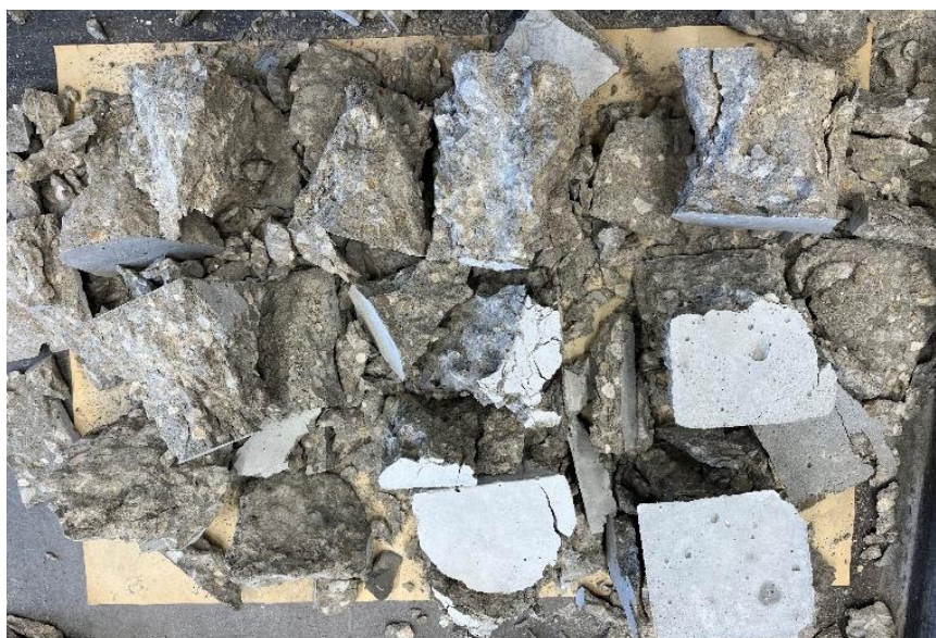
Рисунок 20 - Бетонные образцы после испытания на предел прочности при сжатии
