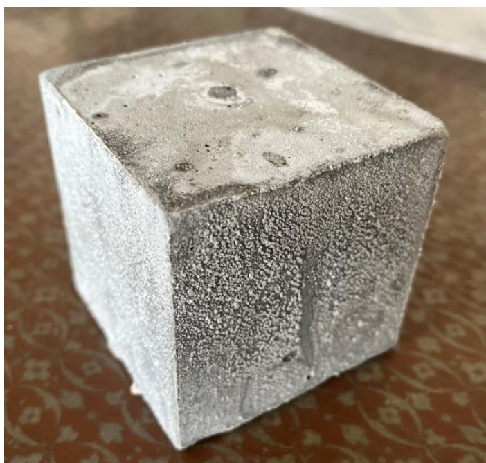
Рисунок 36 – Образец, выдерживаемый в растворе MgSO_4 в течении 90 суток
