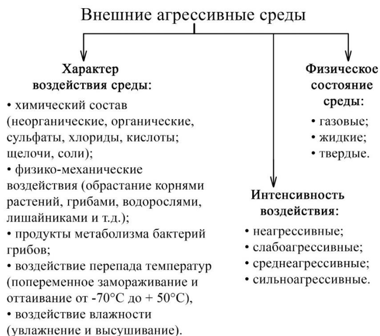
Рисунок 1 – Классификация внешних агрессивных сред, влияющих на бетон и железобетонные конструкции
