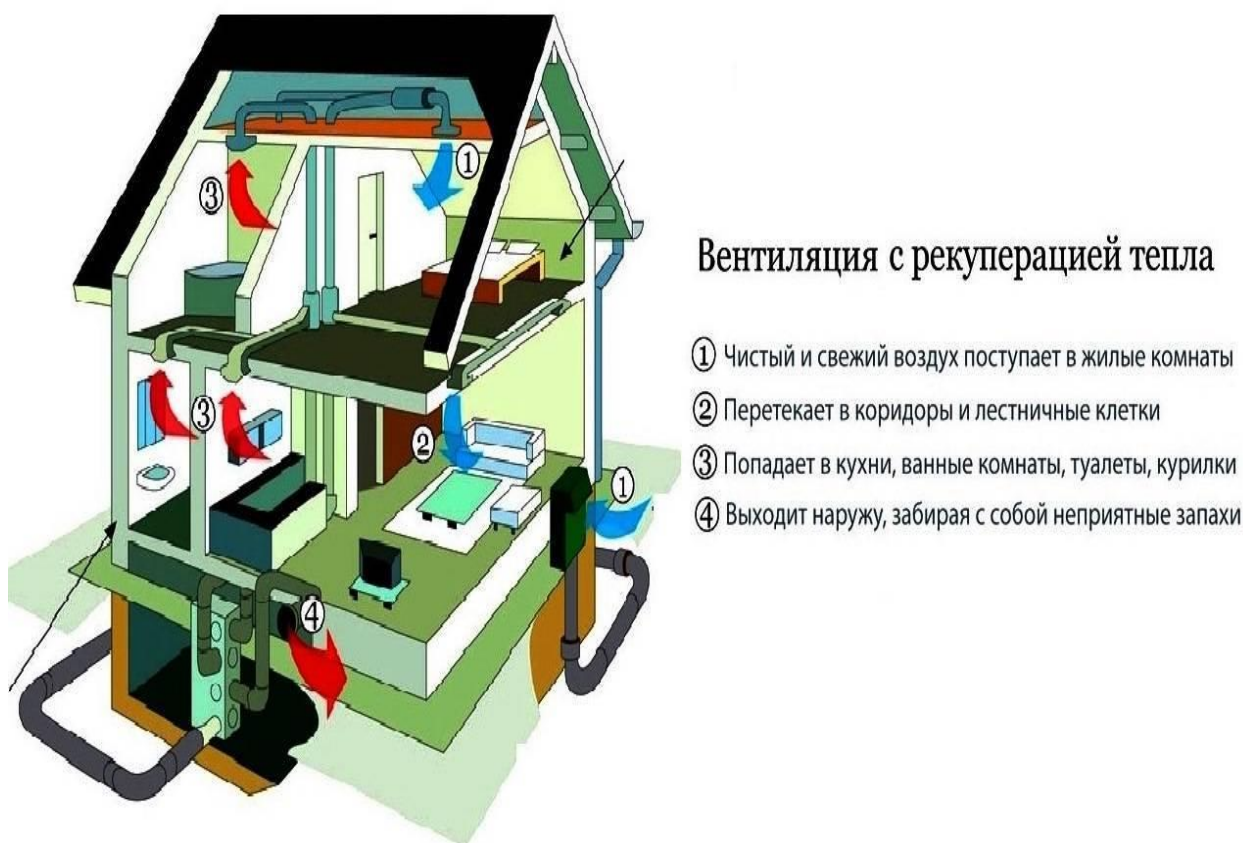
Рисунок 24 – Система вентиляции с рекуперацией тепла
