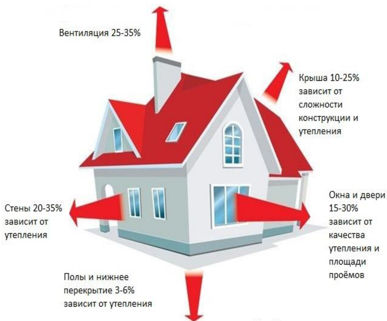
Рисунок 11 – Основные направления потерь в малоэтажном здании
