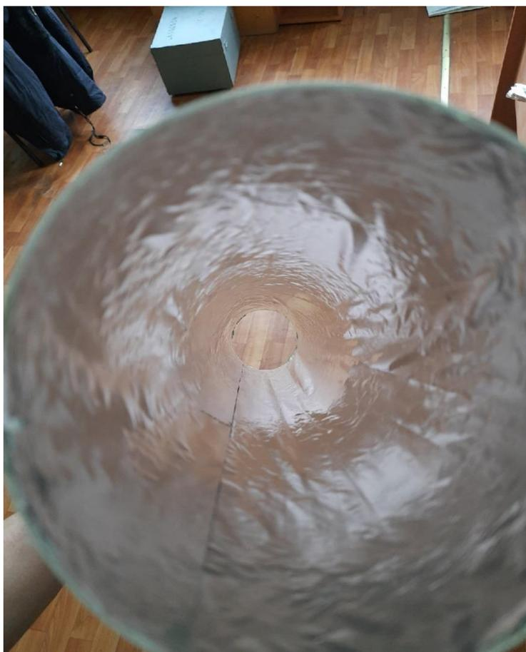
Рисунок 9 – Фольга, вклеенная в ПВХ трубу
