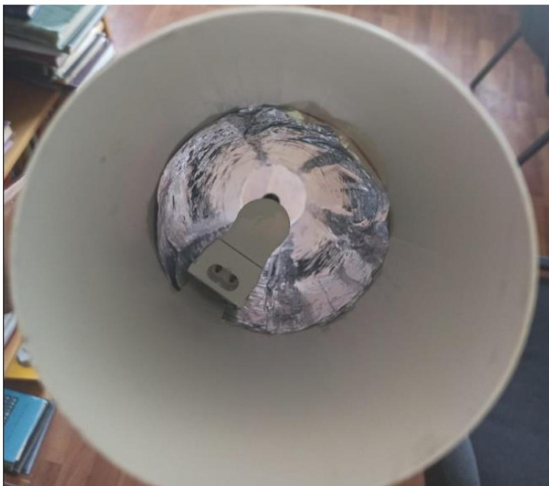
Рисунок 10 – Установка ультрафиолетовой лампы в трубу
