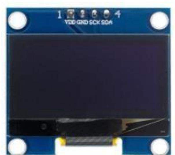
Рисунок 20 – OLED экран 128x64
