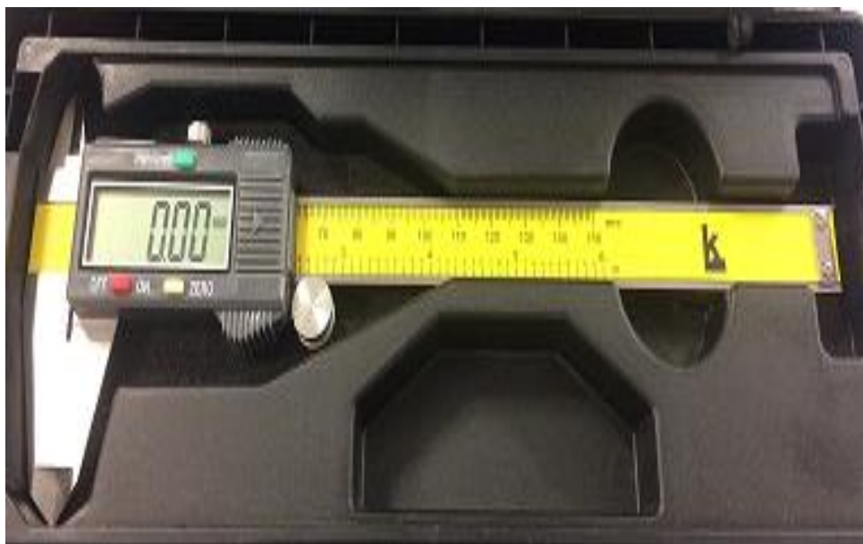
Рисунок 17 - Штангенциркуль электронный КАЛИБРОН ЩЦЦ-1 0-150
