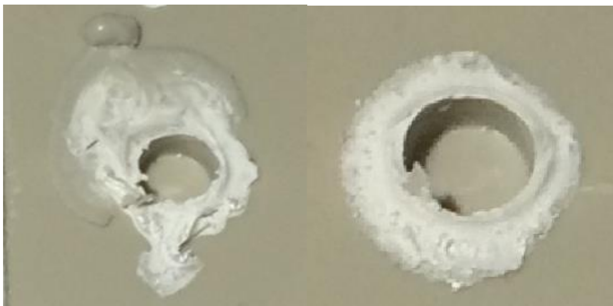
Рисунок 27 - След «сварного шва» на полипропилене; время сварки \geq 3,0 с
