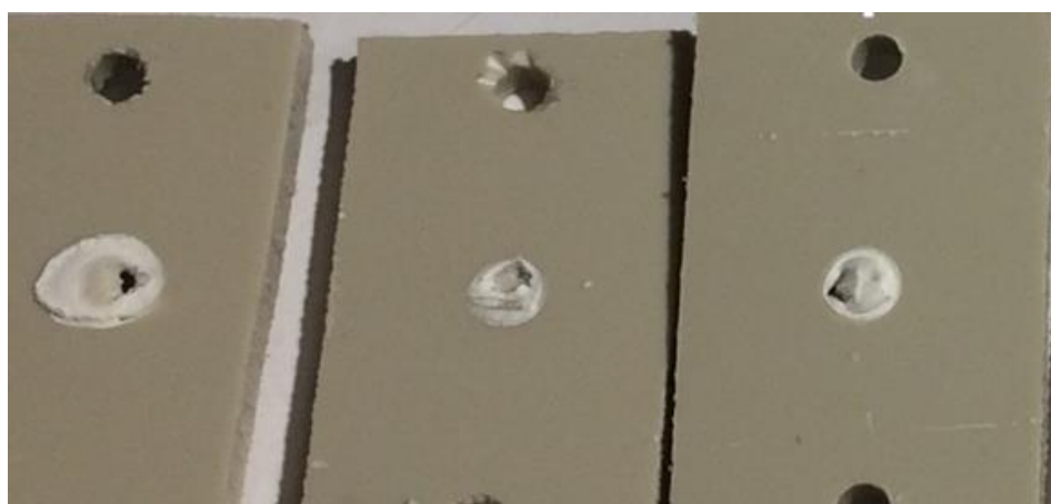
Рисунок 24 – След сварного шва на полипропилене; время сварки (2,0-3,0) с
