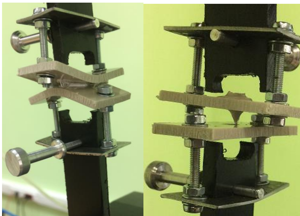
Рисунок 21 - Образцы сварного соединения полипропилена в момент разрушения
