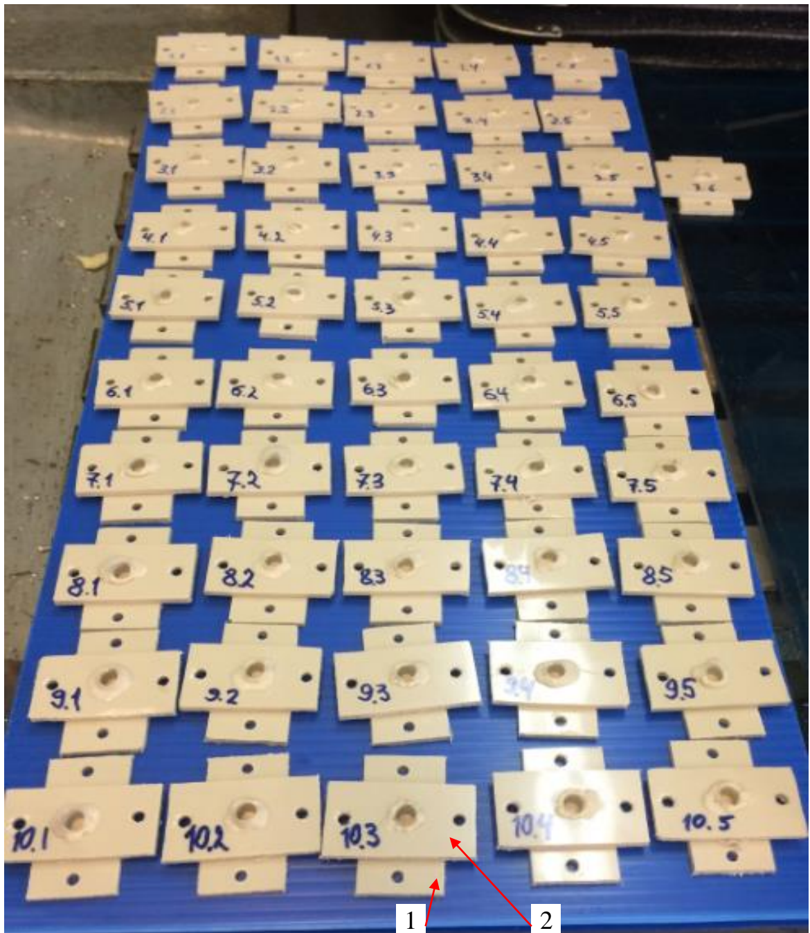
1 и 2 – образцы сварных соединений пластин
