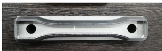
Рисунок 25 - Вырубной нож, лопатка тип 2
