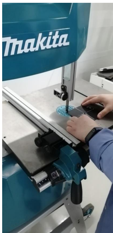
Рисунок 16 - Процесс изготовления образцов на ленточной пиле Makita
