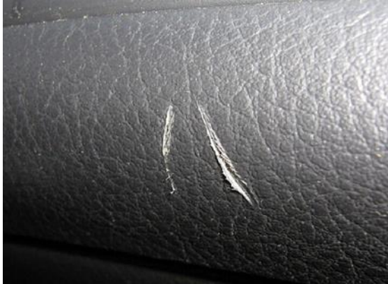
Рисунок 3 – Дефект типа «царапины» на деталях интерьера салона автомобиля
