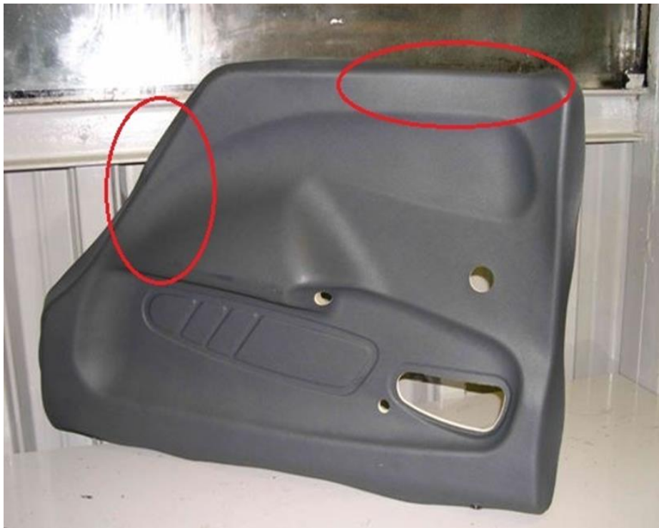
Рисунок 4 – Дефект типа «коробление» на обивки двери из жесткого ППУ
