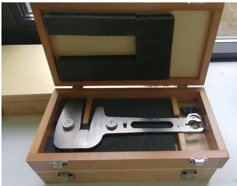
Рисунок 14 - Молот Шарпи с запасом энергии 2 Дж
