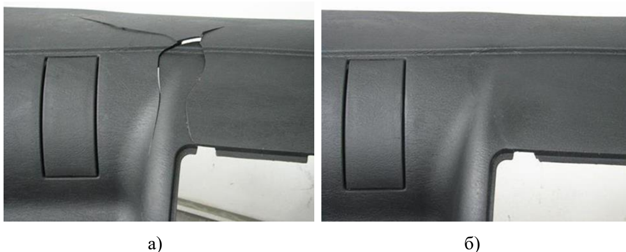
Рисунок 1 – Дефект типа «разрушение, образование трещин»
