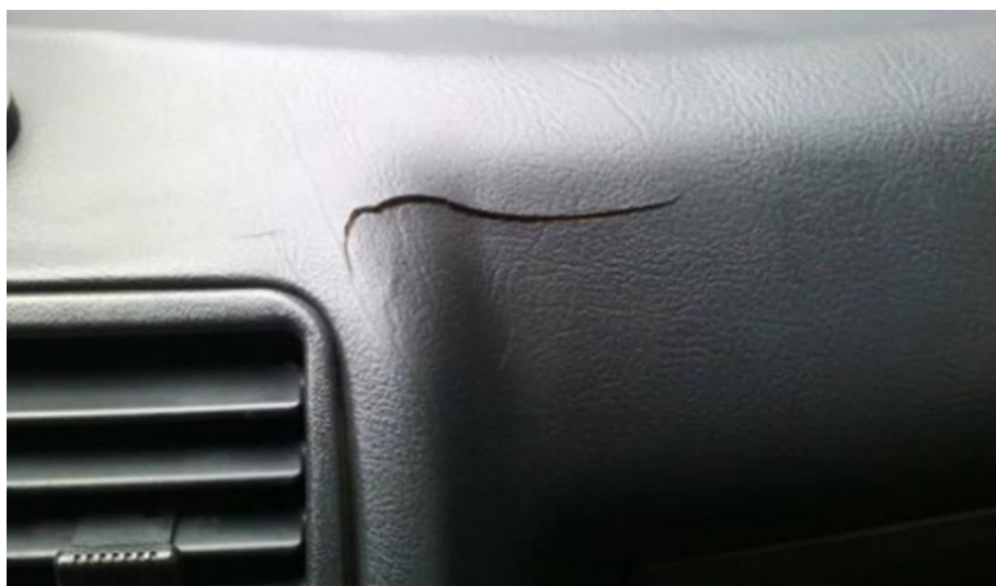
Рисунок 2 – Дефект типа «трещина» на панели приборов
