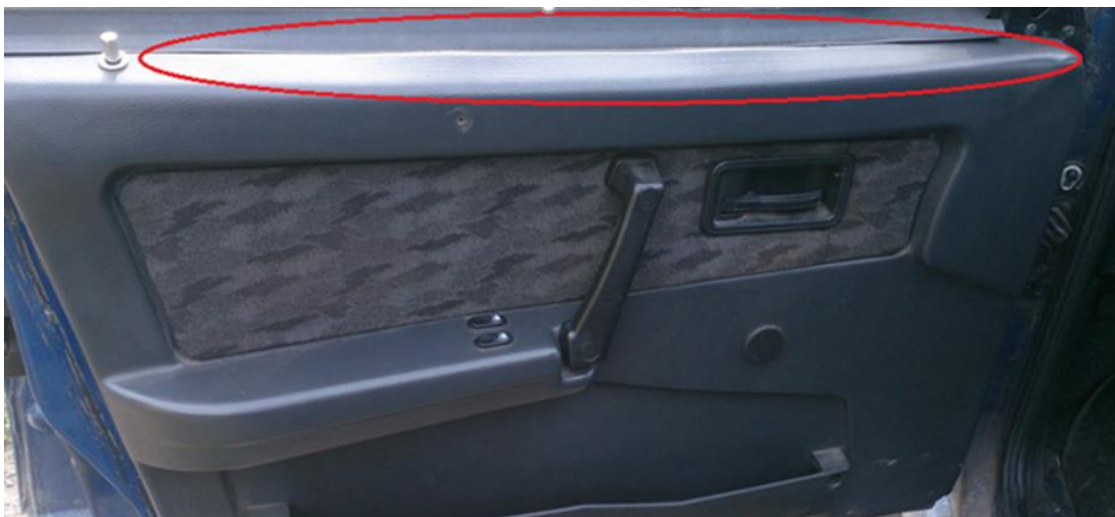
Рисунок 5 – Дефект типа «коробление» обивки двери из жесткого ППУ (в процессе эксплуатации)
