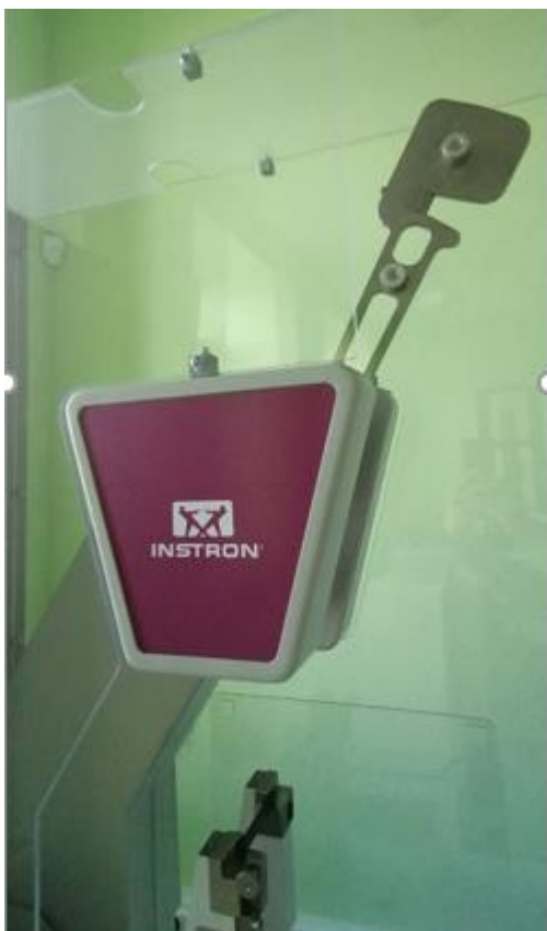
Рисунок 20 - Проведение испытаний ударная вязкость по Шарпи
