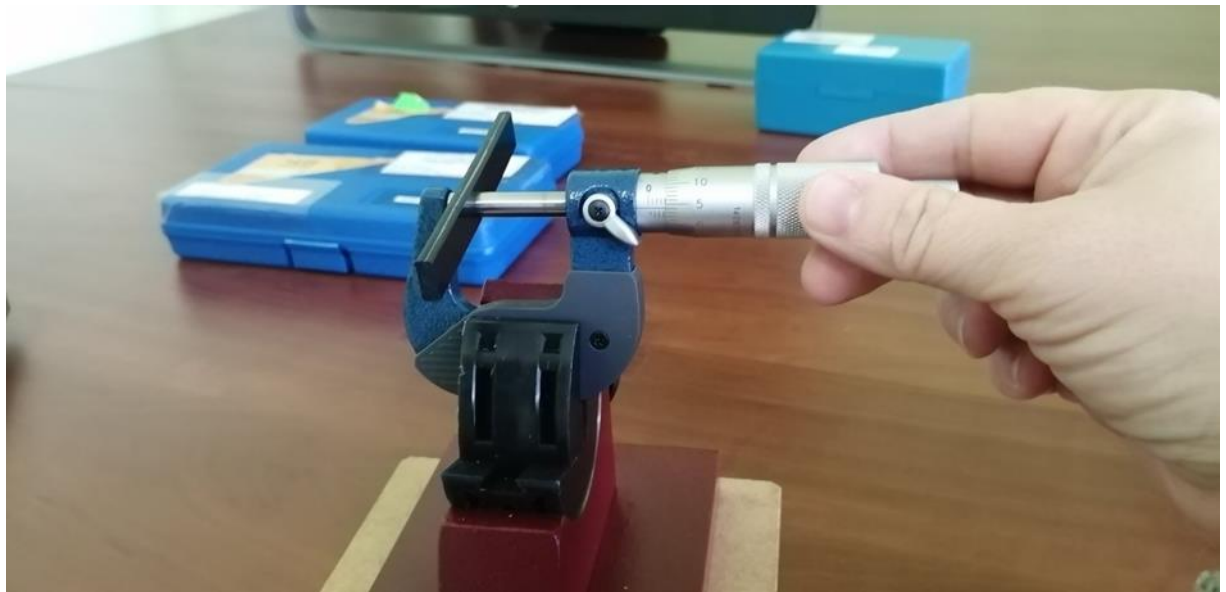
Рисунок 19 - Замеры размеров образцов микрометром МК-25 0.01 ЧИЗ
