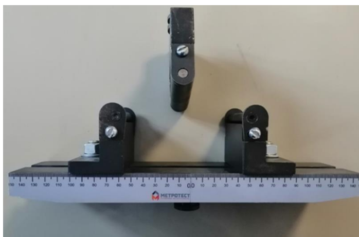
Рисунок 26 - Оснастка для испытаний на изгиб
