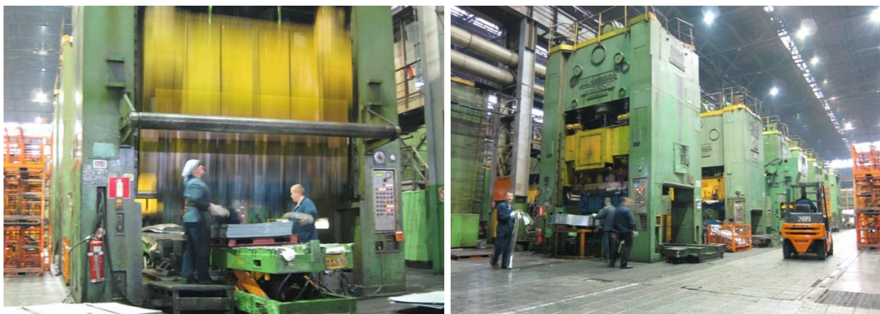
Рисунок 1 – Прессы двойного действия
