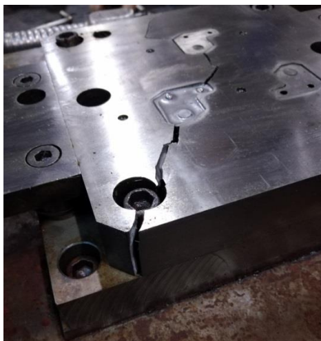
Рисунок 3 – Пример вышедшего из строя штампа в результате аварии – разрушение штампа
