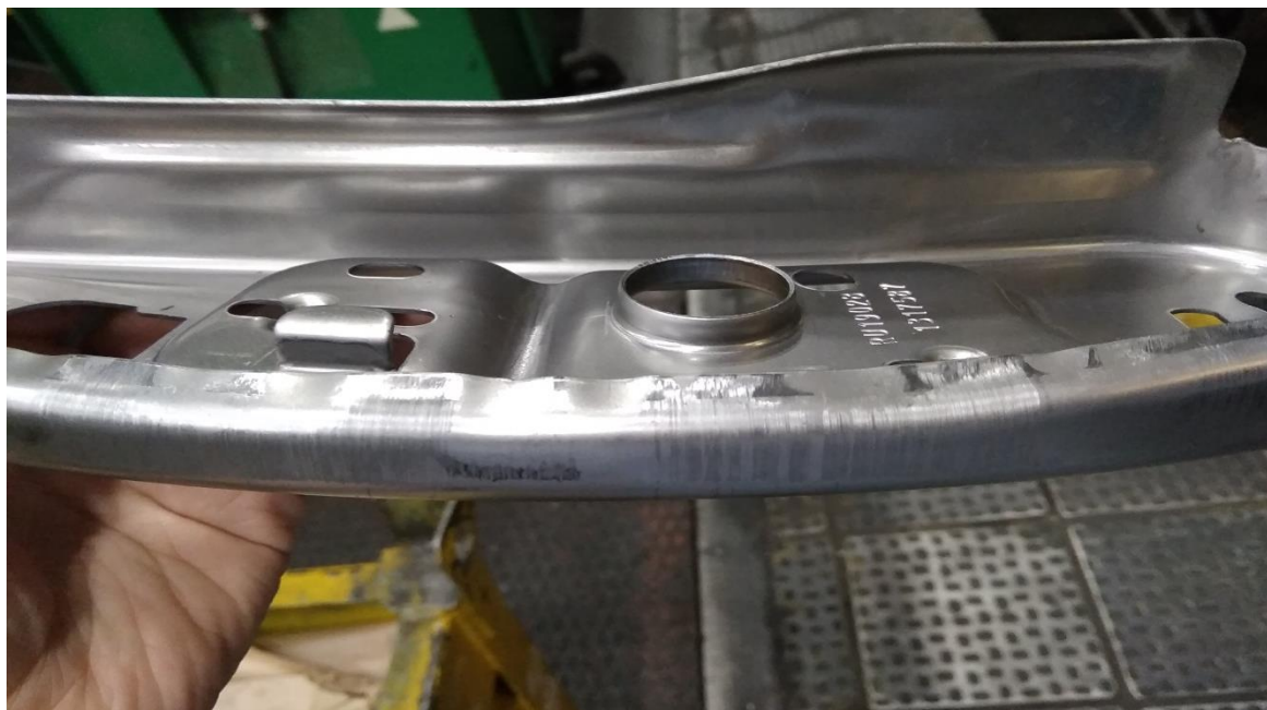
Рисунок 4 – Примеры дефектов деталей при износе прессового штампа
