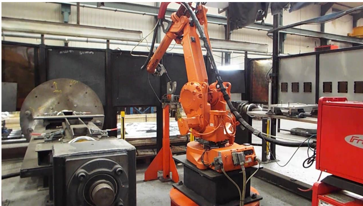
Рисунок 32 – Роботизированный комплекс для восстановительной наплавки со сварочным оборудованием Fronius и роботом KUKA
