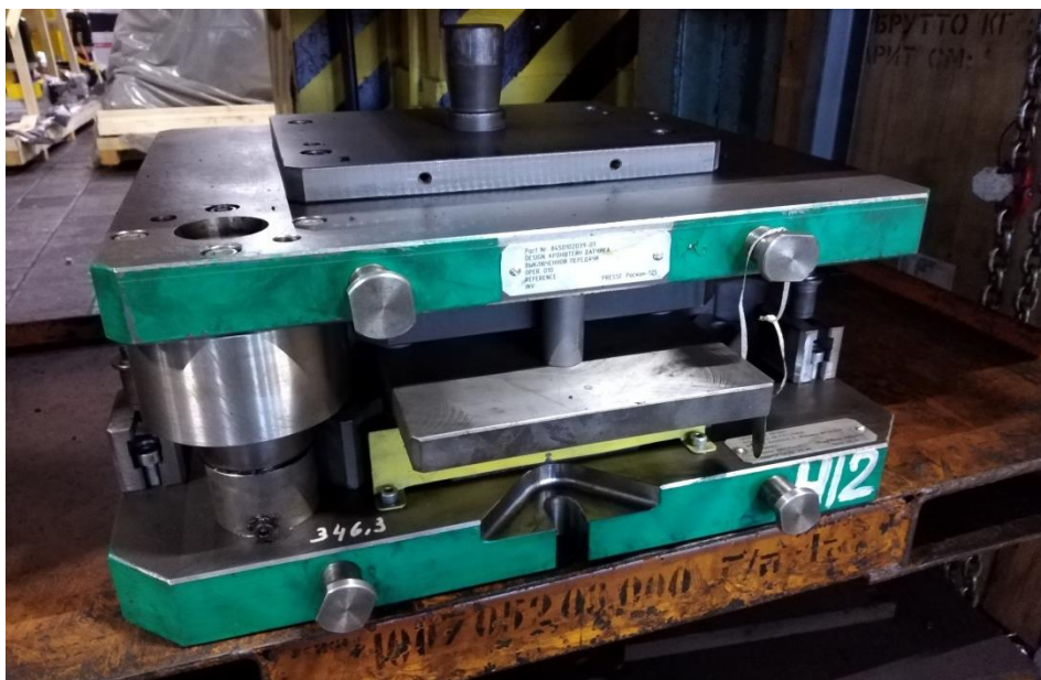
Рисунок 2 – Примеры штамповой оснастки
