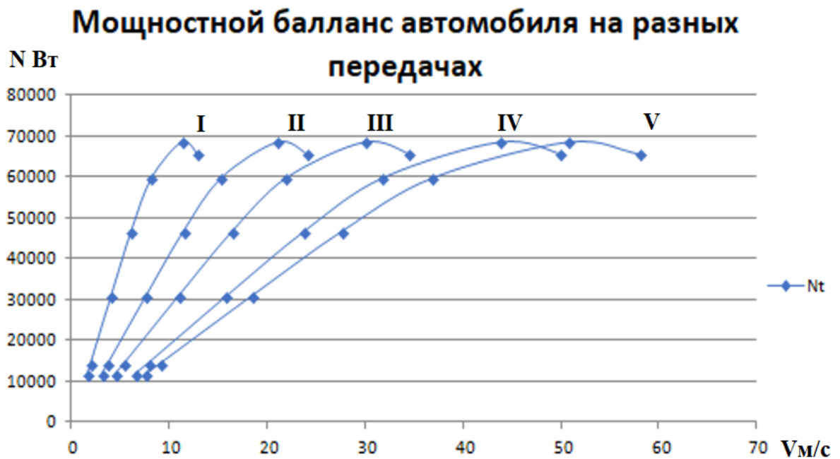
Рисунок 16 – Мощностной баланс автомобиля на разных передачах
