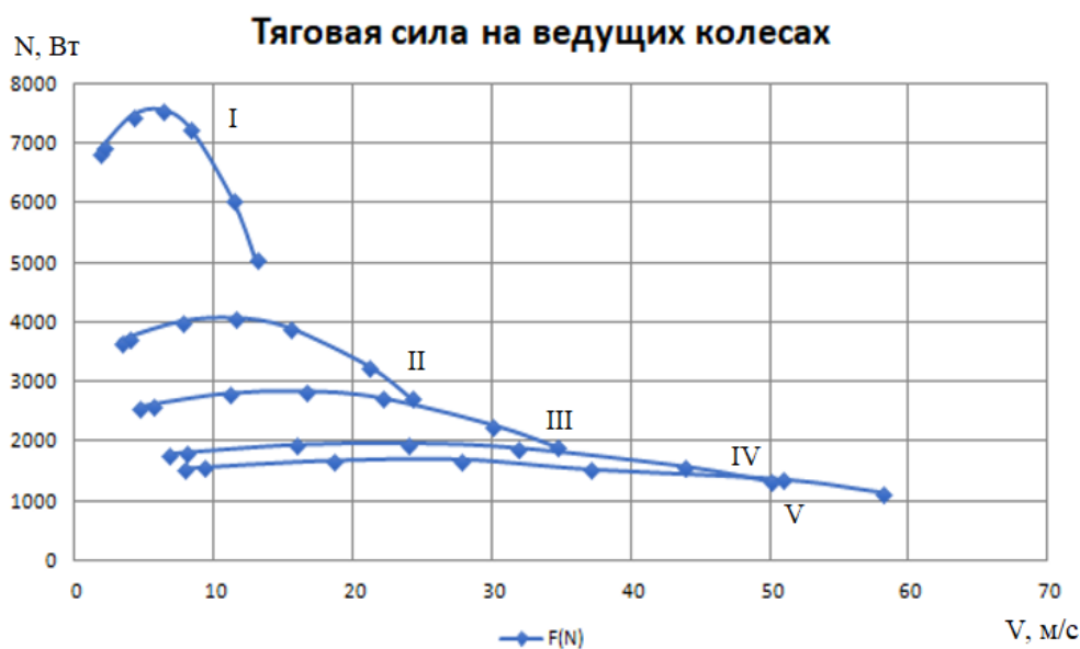
Рисунок 8– График зависимости Скорости V от Силы тяги F_t
