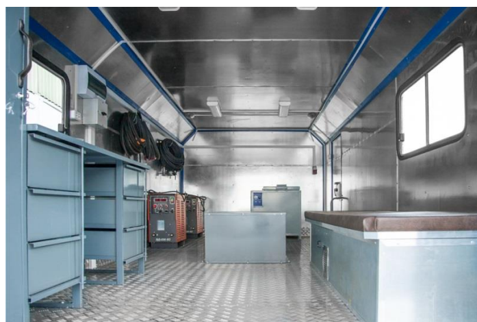
Рисунок 2 – Передвижная мастерская на базе ГАЗ 33081
