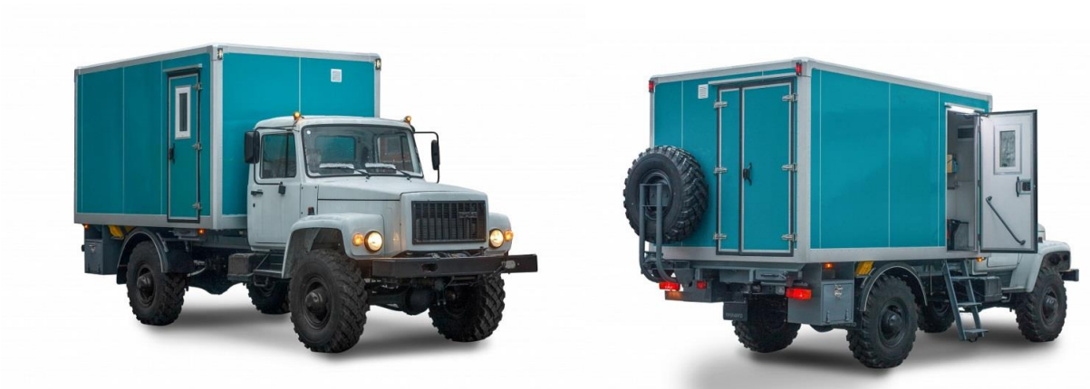
Рисунок 3 – Автомобиль-мастерская на шасси ГАЗ 33081
