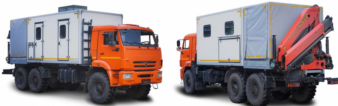
Рисунок 4 – Передвижная техническая помощь с КМУ на шасси КамАЗ-43118
