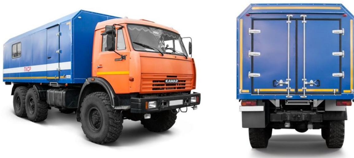
Рисунок 1 – Мастерская передвижная на шасси КамАЗ-43118
