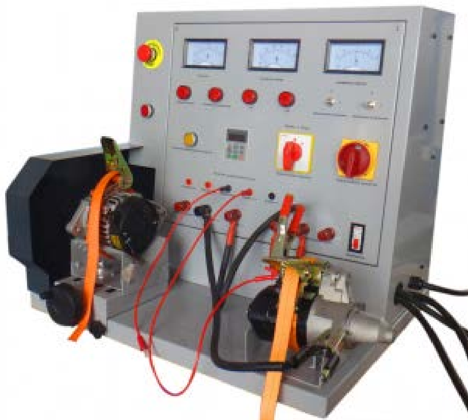
Рисунок 2 – Электрический стенд для проверки генераторов и стартеров KraftWell KRW220Inverter
