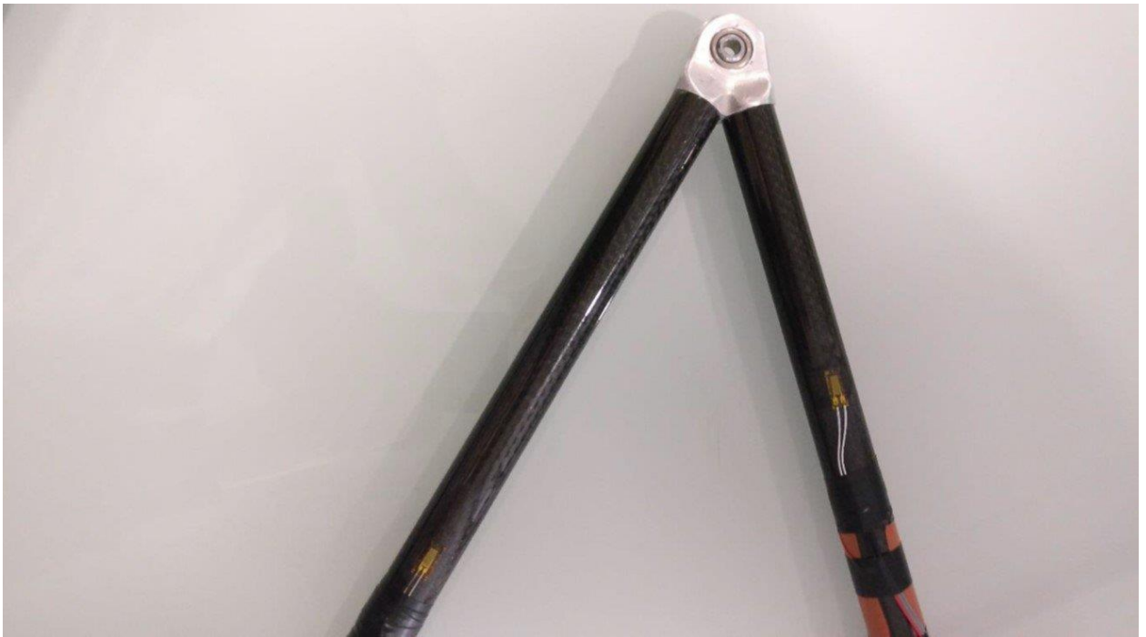
Рисунок 8 – Рычаг подвески болида, выполненный из композитных материалов
