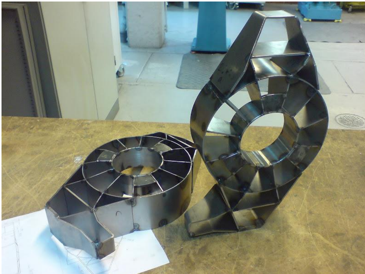
Рисунок 9 – Стальные сварные кулаки подвески
