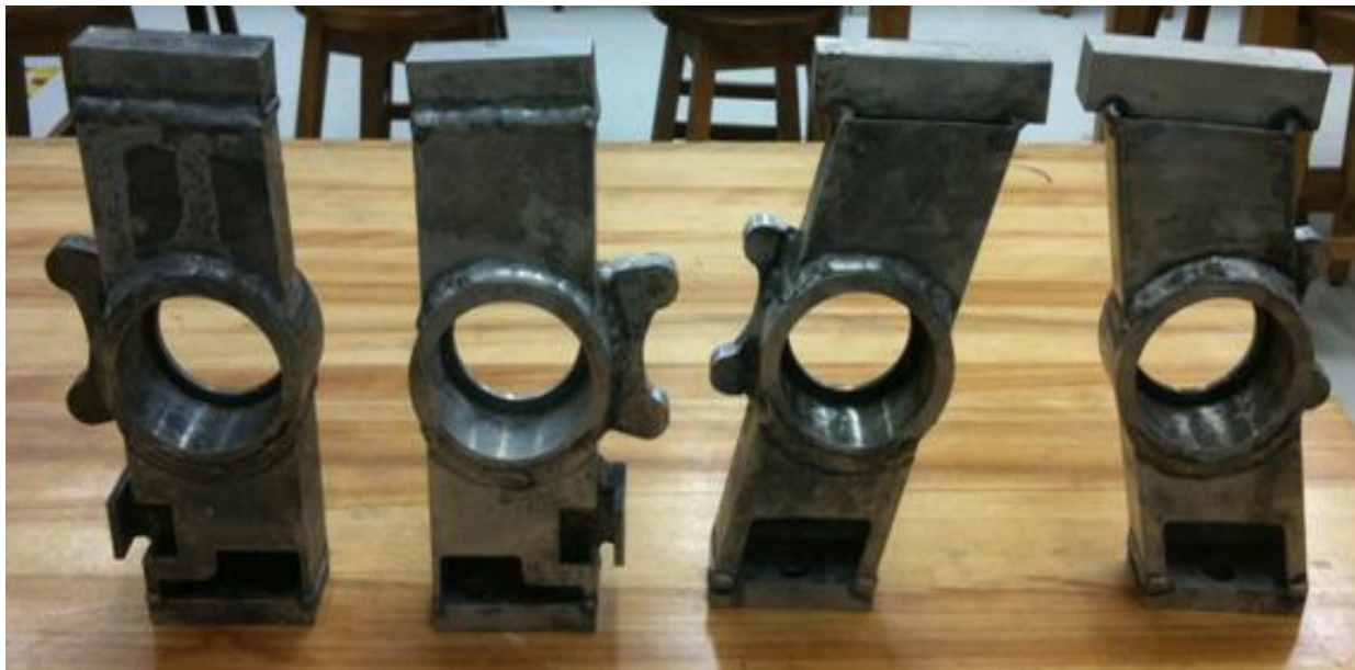
Рисунок 10 – Сварные алюминиевые кулаки подвески
