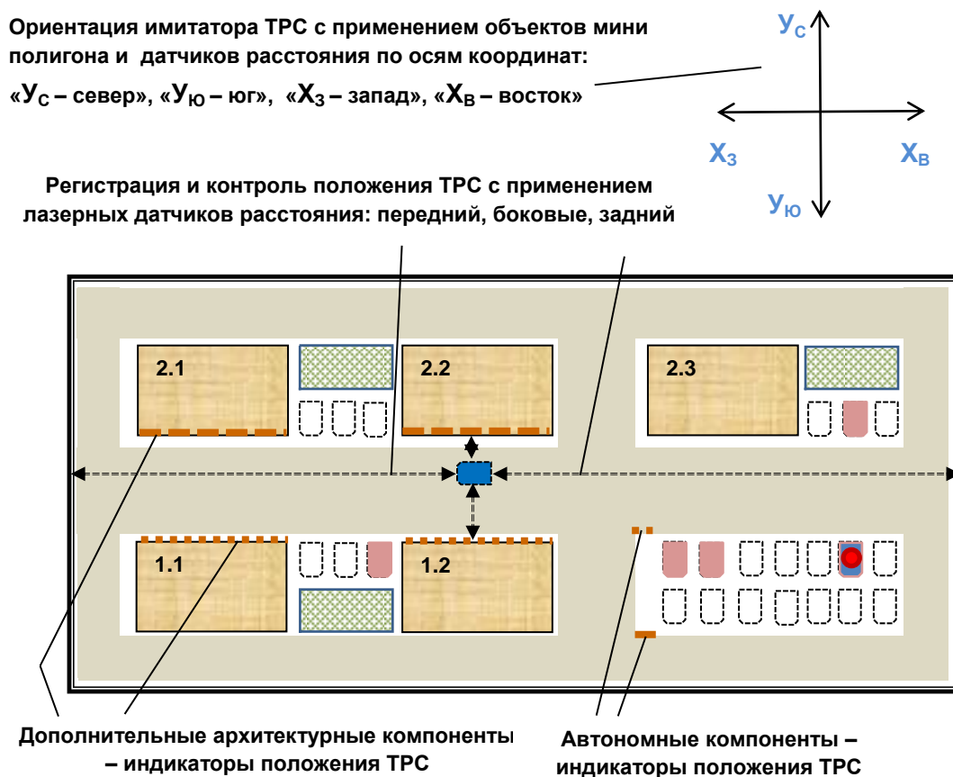
Рисунок 8 – Пространственная ориентация имитатора беспилотного транспортного средства на мини-полигоне
