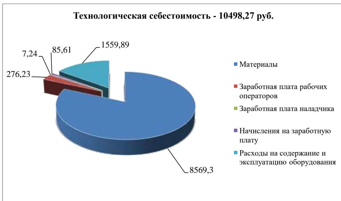
Рисунок 12 – Расчет элементов технологической себестоимости изготовления детали «Пуансон»
