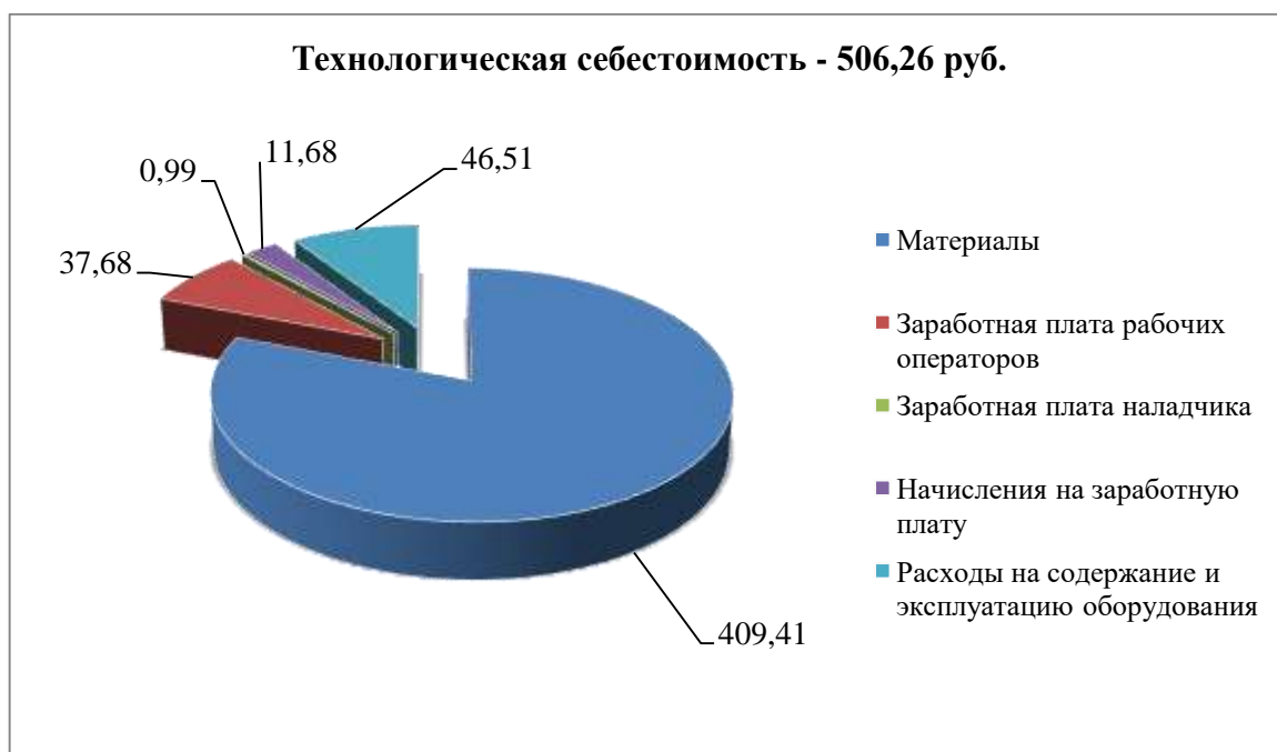
Рисунок 8 – Расчет элементов технологической себестоимости изготовления детали «Вторичный вал»
