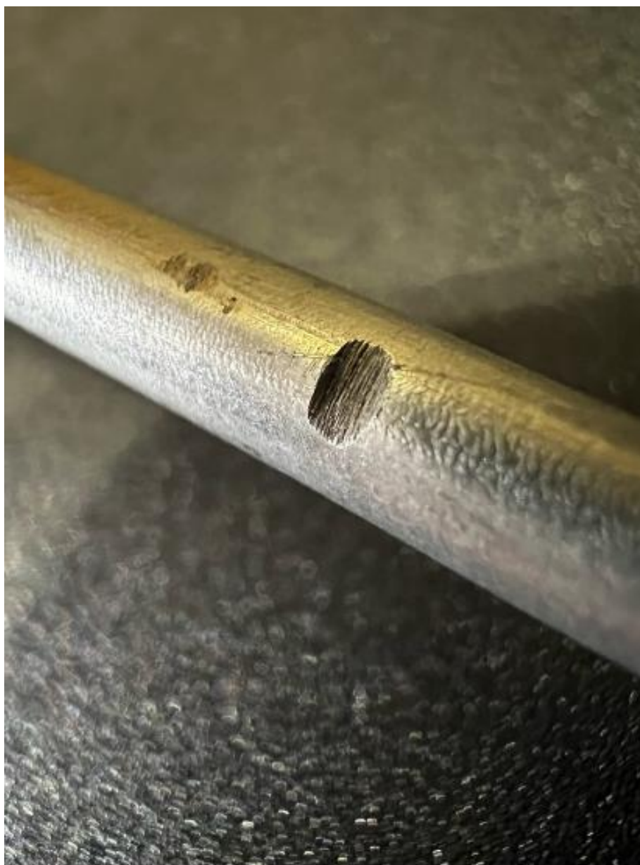
Рисунок 46 – Результат эксперимента на стойкость к истиранию тормозной трубки без защитных рукавов
