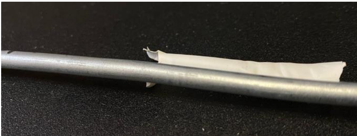
Рисунок 50 – Отсутствие следов износа на тормозной трубке
