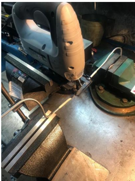
Рисунок 48 – Испытательная установка с закреплённой тормозной трубкой с защитным рукавом
