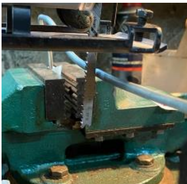
Рисунок 45 – Касание обратной стороны пилки о тормозную трубку
