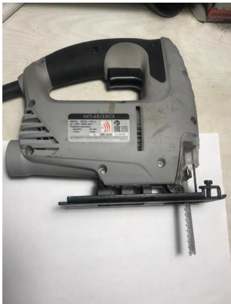
Рисунок 42 – Электрический лобзик с развернутой пилкой
