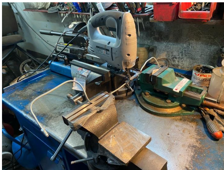
Рисунок 44 – Испытательная установка с закреплённой тормозной трубкой
