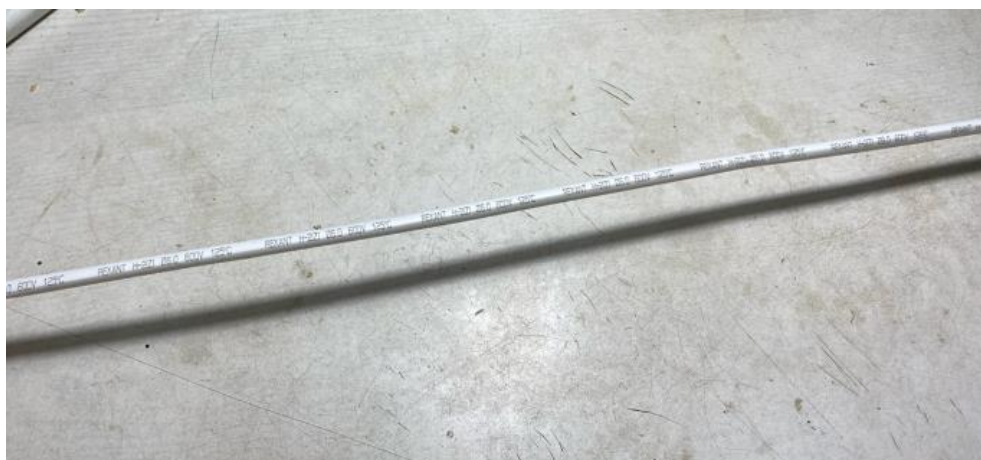
Рисунок 41 – Термоусадка в качестве защитного рукава
