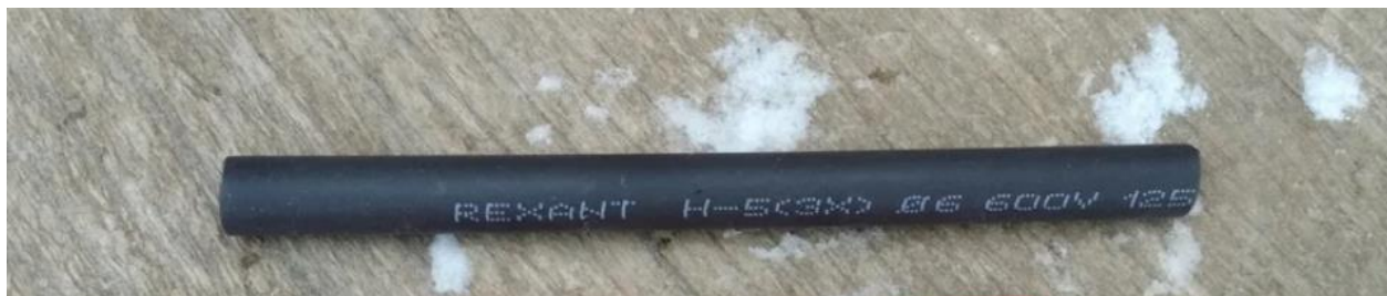
Рисунок 52 – Термоусадка в качестве защитного рукава
