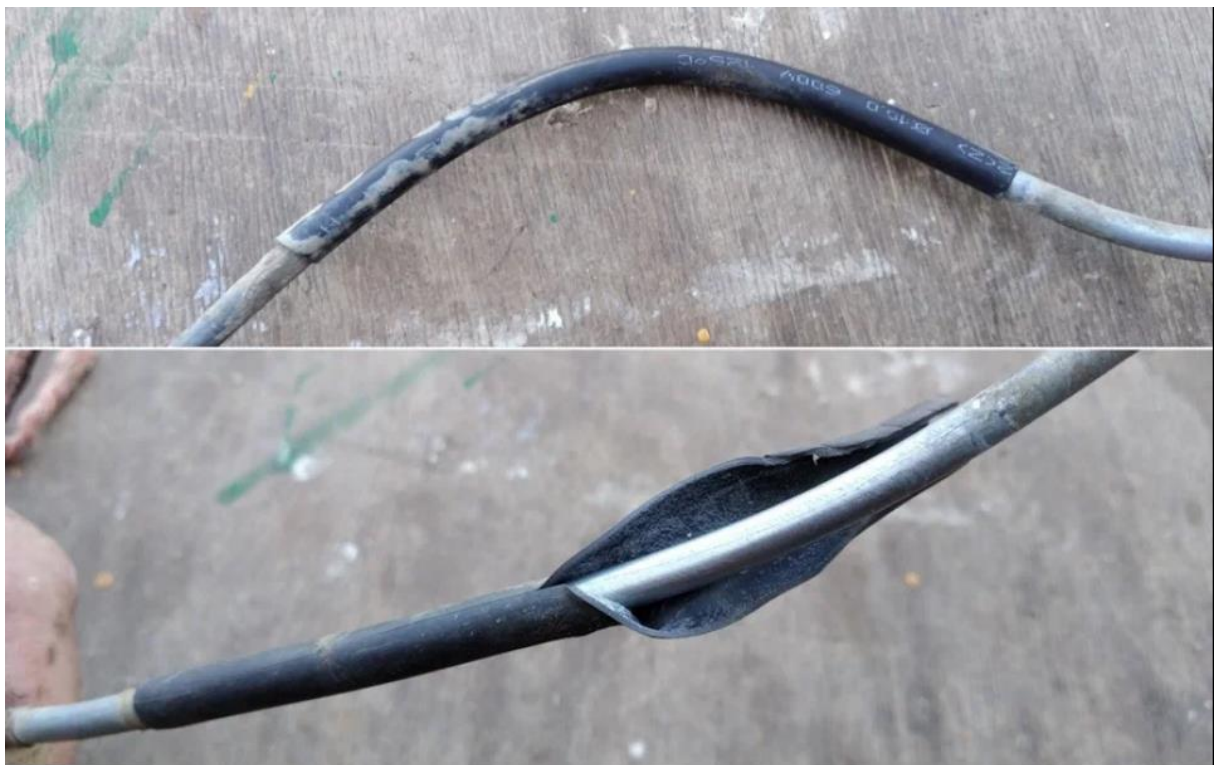
Рисунок 55 – Результат эксперимента стойкости к коррозии
