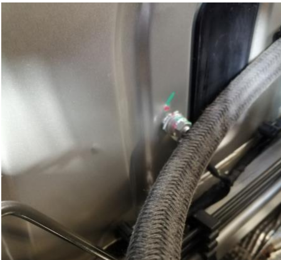
Рисунок 33 – Перетираание шланга ВУТ об шпильку массы
