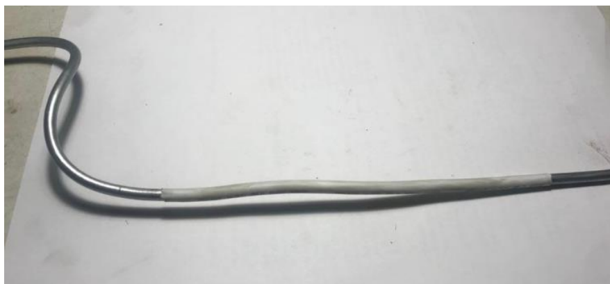
Рисунок 47 – Термоусадка на тормозной трубке в качестве защитного рукава
