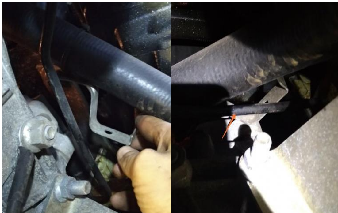
Рисунок 27 – Протираание тормозных трубок об незакреплённый кронштейн
