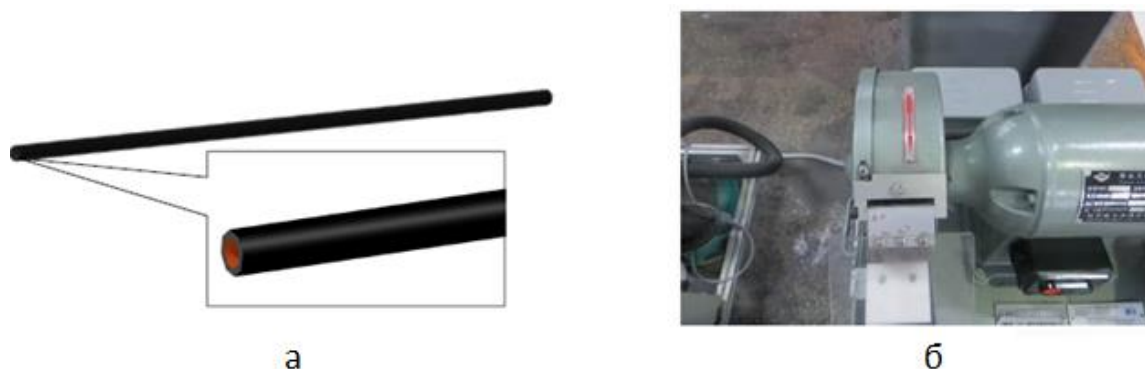
Рисунок 10 – Шлифование торцов трубки: а – торец тормозной трубки; б – шлифовальный станок
