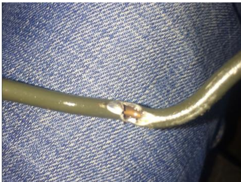
Рисунок 25 – Последствие перетирания тормозной трубки
