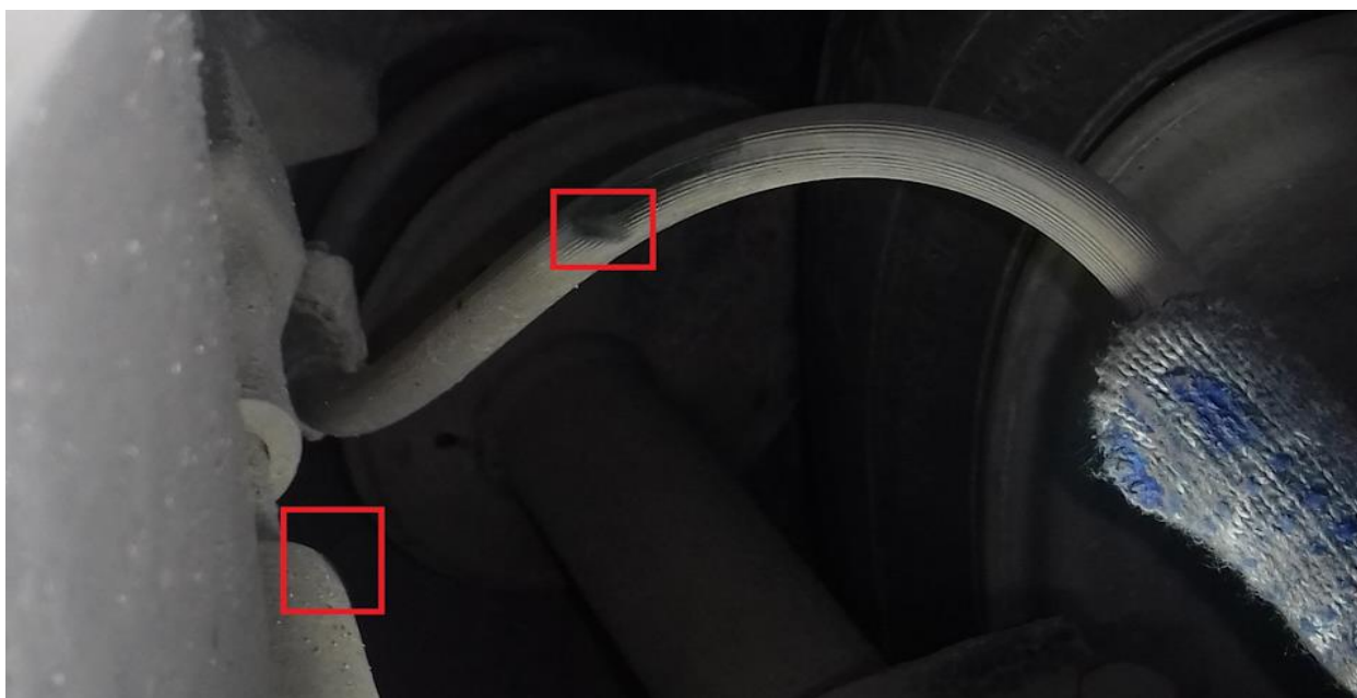
Рисунок 32 – Протирание передних тормозных шлангов об дефлекторы
