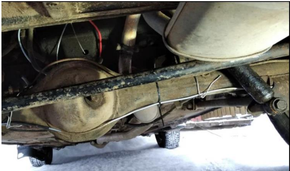
Рисунок 54 – Закрепленная тормозная трубка с термоусадкой
