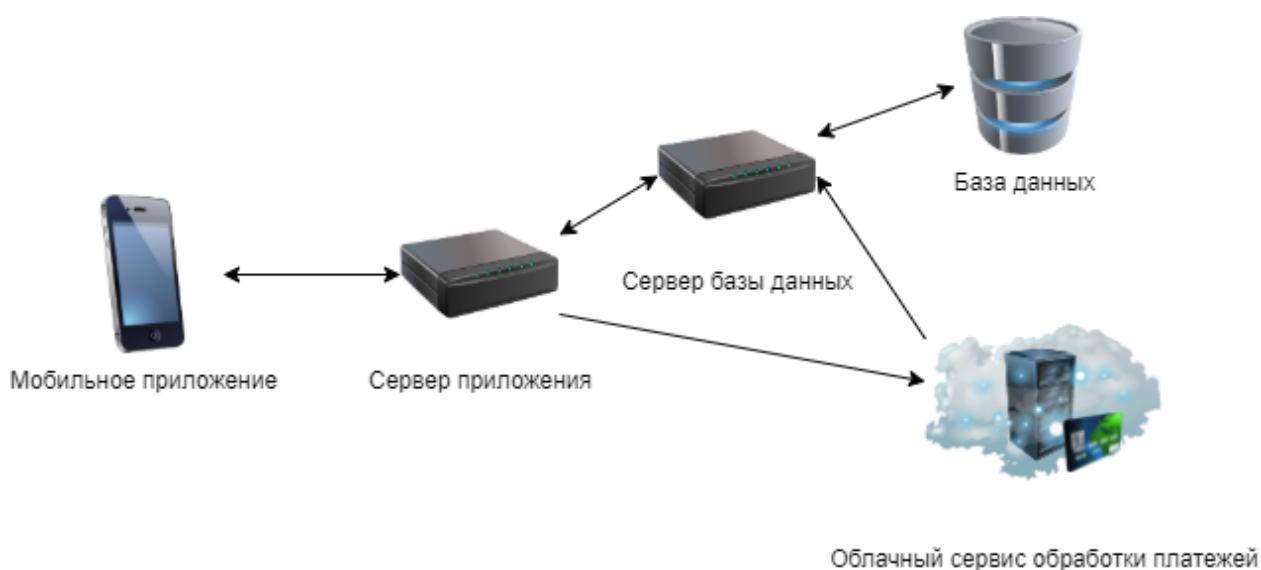
Рисунок 11 – Схема взаимодействия компонентов мобильного приложения
