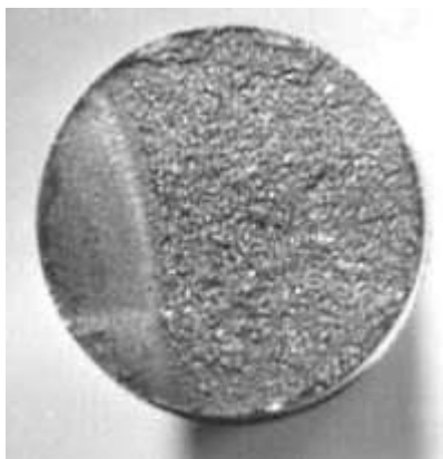
Рисунок 10 – Усталостный излом при одном источнике разрушения
