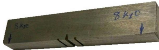
Рисунок 27 – Образец для испытаний магниевого сплава на усталость
