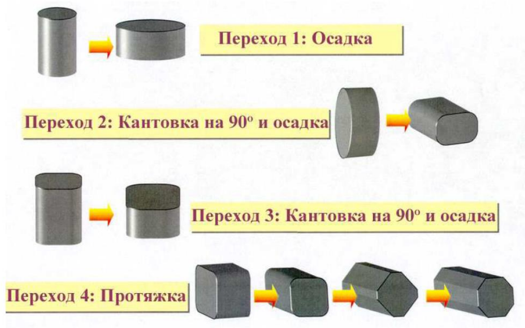
Рисунок 22 – Последовательность операций всестороннейковки
