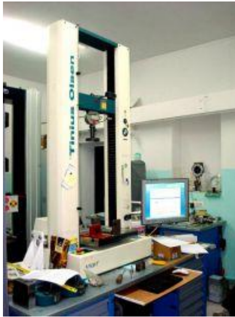
Рисунок 26 - Универсальная испытательная машина Н50КТ, с компьютерным управлением предназначена для определения механических свойств материалов
