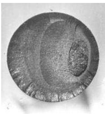
Рисунок 11 – Усталостный излом при больших нагрузках.
