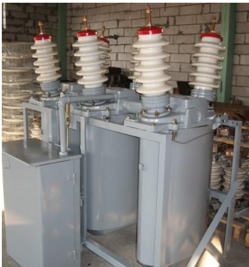
Рисунок 4 – Внешний вид выключателя марки ВТ – 35 кВ
