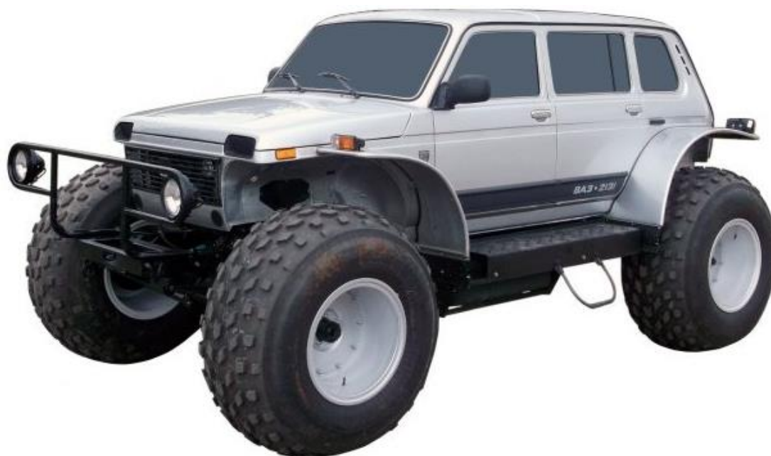
Рисунок 3 – Снегоболотоход «Марш Лонг (1922-10) с кузовом от пятидверной «Нивы» ВАЗ-2131
