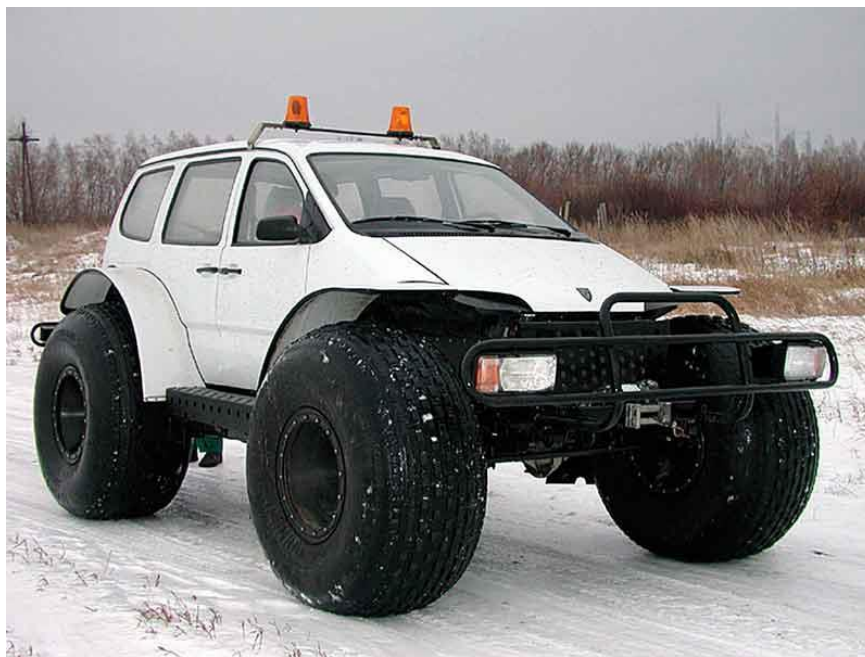
Рисунок 2 – Снегоболотоход «Марш-2» (1922-10) с кузовом от минивэна ВАЗ-2120 «Надежда»
