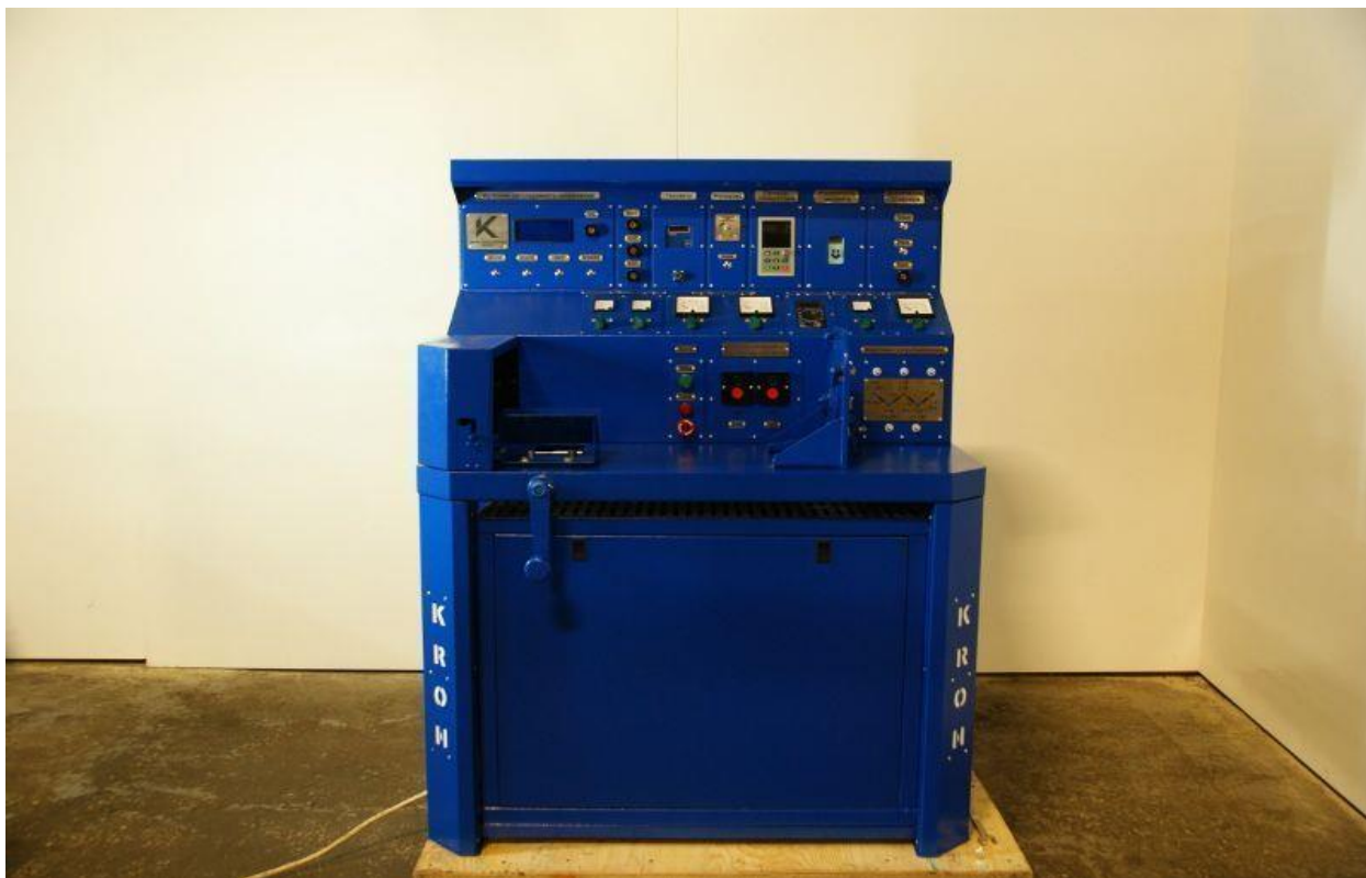
Рисунок 12 – Стенд Э-250-02 для испытаний генераторов и стартеров
