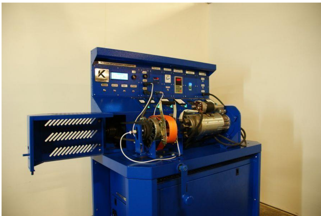
Рисунок 11 – Стенд Э-250-02 для испытаний генераторов и стартеров
