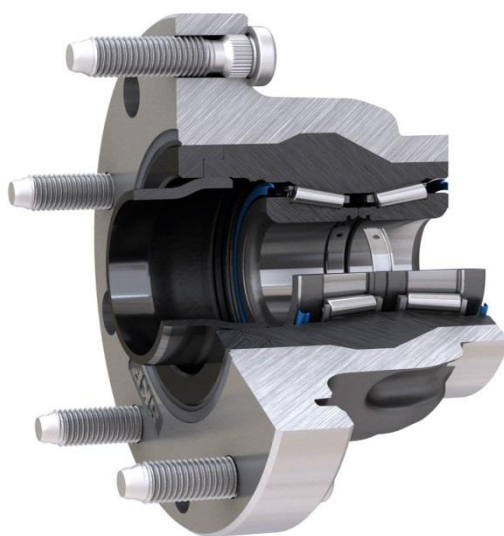
Рисунок 4 – Ступичный узел HUB 3 с двухрядным роликовым подшипником
