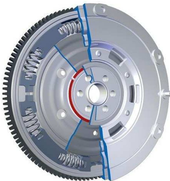
Рисунок 6 - Схема двухмассовой системы маховика
