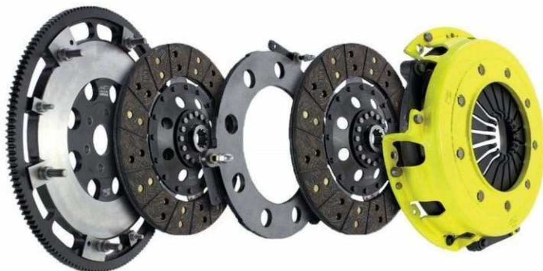
Рисунок 5 - Элементы сцепления двухдискового типа
