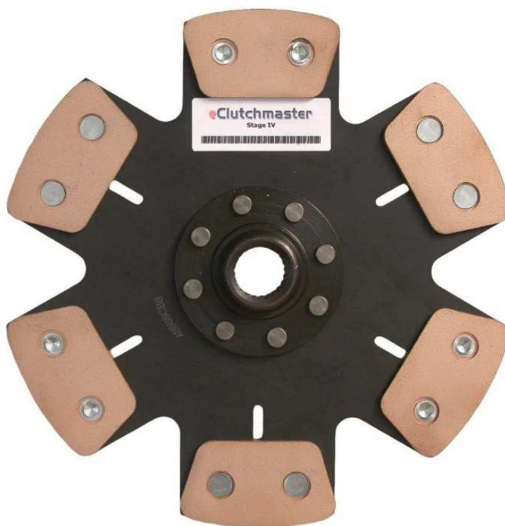
Рисунок 7 - Сцепление диска с керамической фрикционной накладкой
