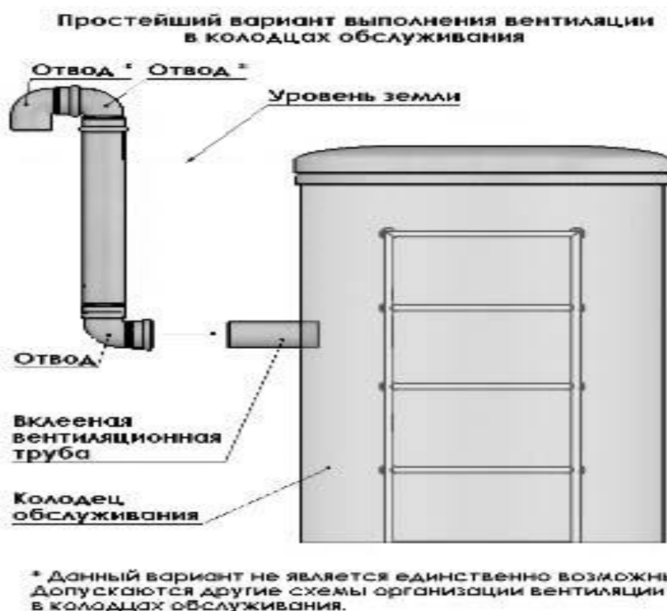
Рисунок 8 – Схема установки вентиляционного патрубка
