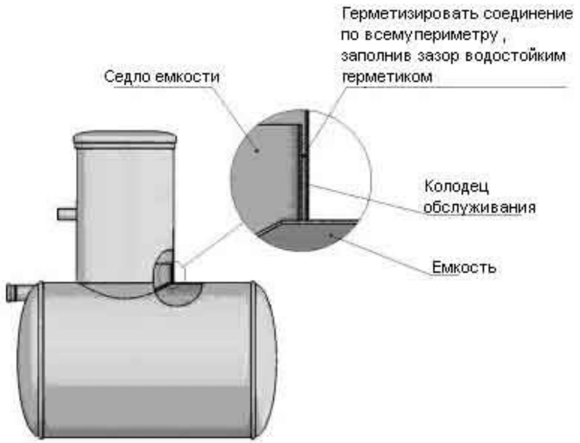
Рисунок 7 – Схема установки технического колодца
