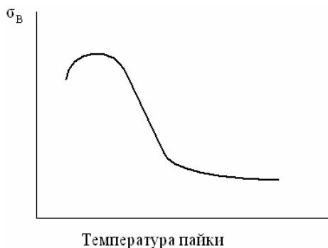
Рис. 2.13. Возможный характер зависимости прочности ПС от температуры пайки: \sigma_B — прочность на растяжение
