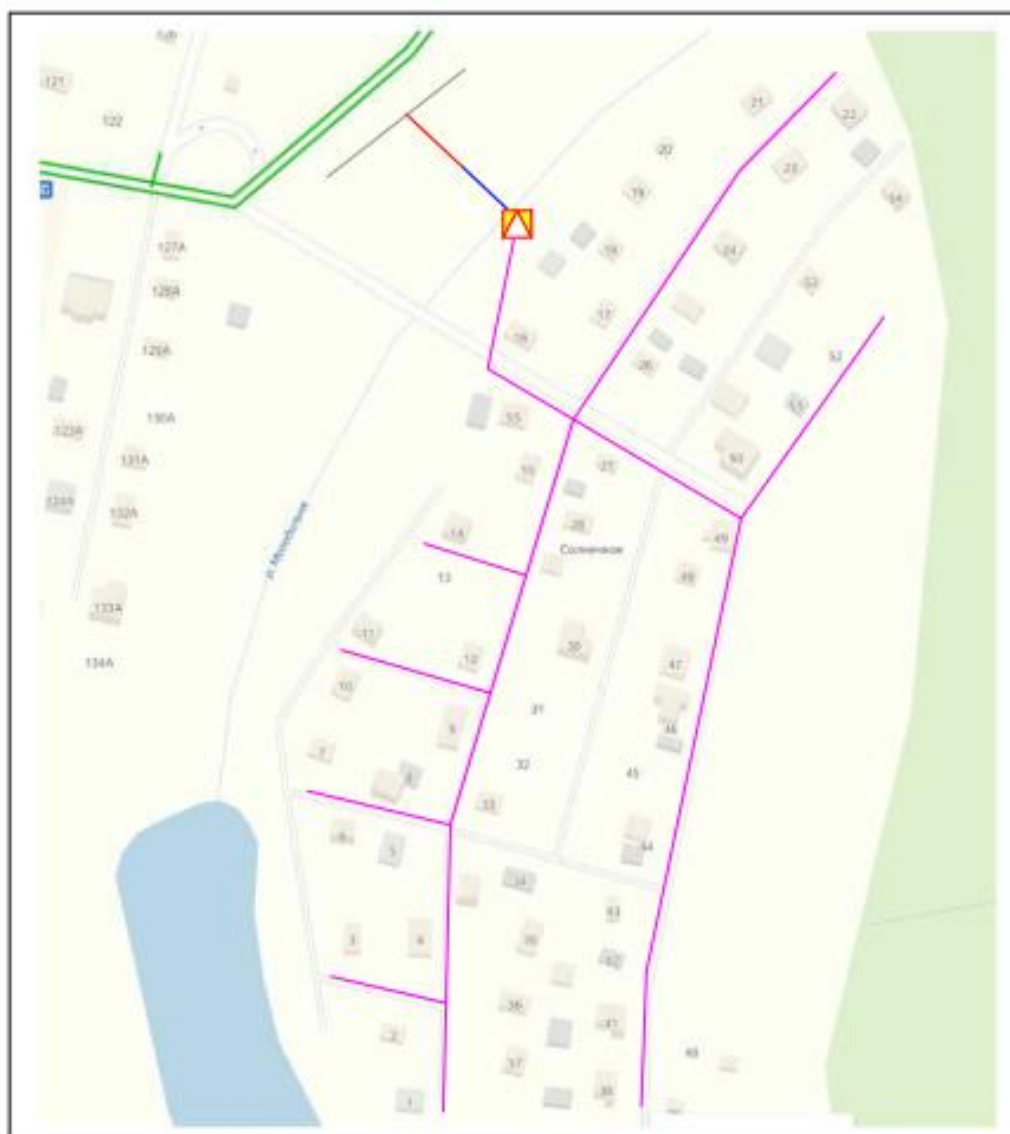
Рисунок 1 – План трасс питающих сетей 10 кВ и 0,38/0,22 кВ на местности системы электроснабжения ПГТ «Майна» городского округа города Саяногорск с учётом подключения новых потребителей
