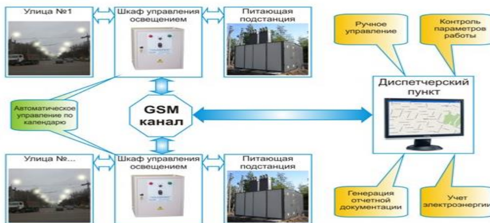
Рисунок 2 - Блок управления наружным освещением
