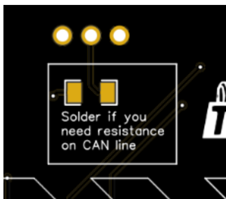
Рисунок 47 – Перемычка для подключения сопротивления на CAN шине
