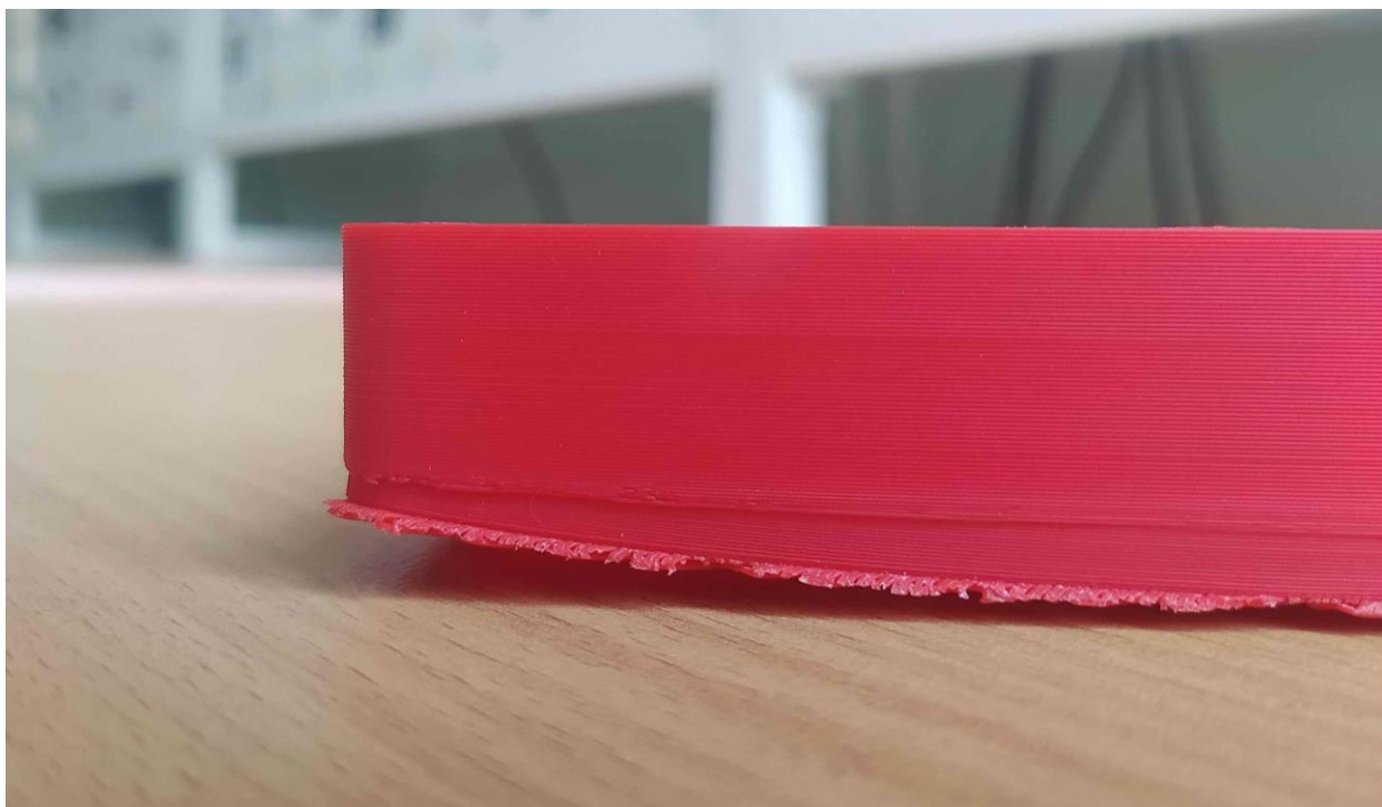
Рисунок 2. – Отслоение углов модели, напечатанной PLA пластиком на 3D принтере Flashforge Adventurer 3
