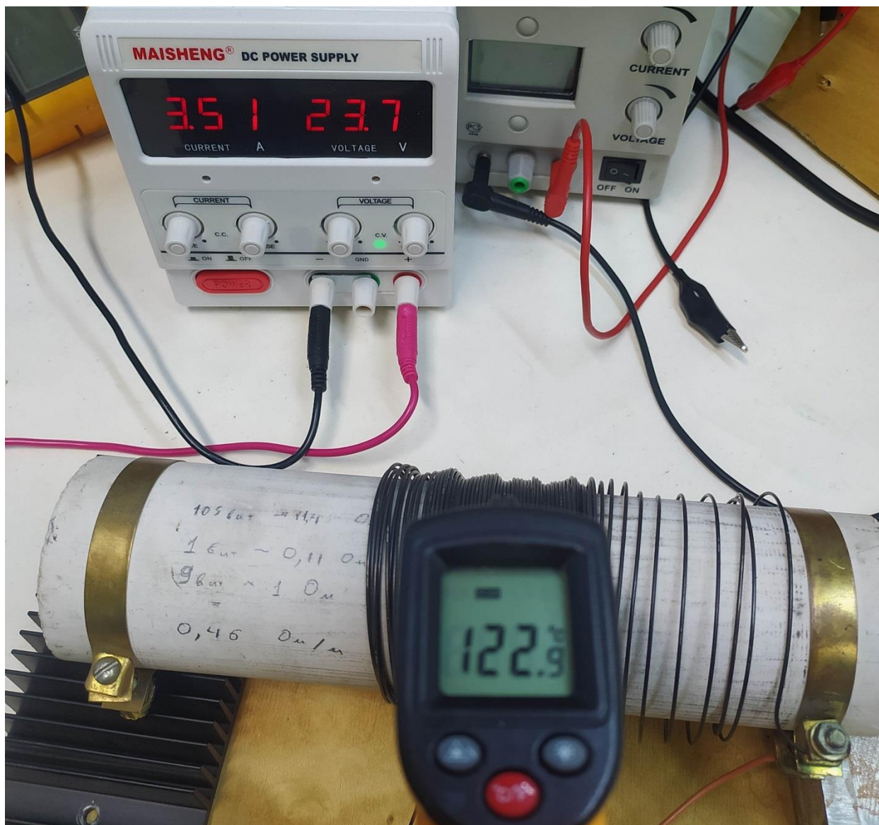
Рисунок 15 – Практический эксперимент по исследованию проволоки.
