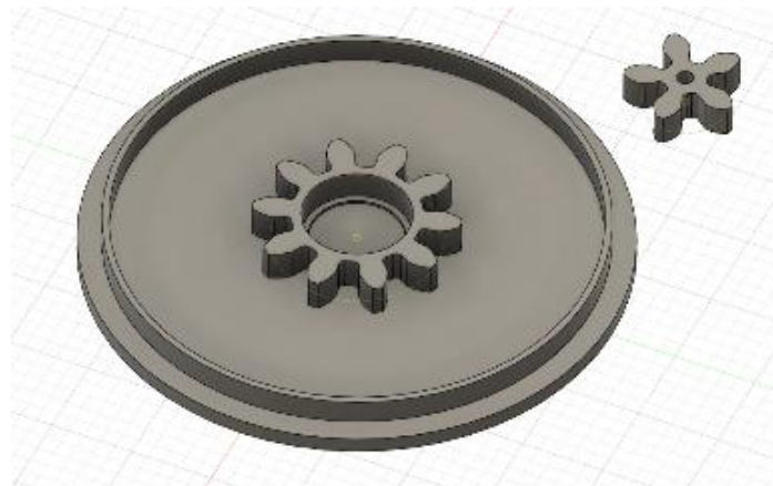
Рисунок 27 – готовая верхняя поверхность и шестерня для двигателя
