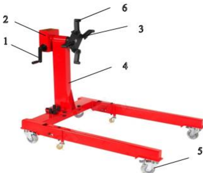
1 – рукоятка; 2 – червячный редуктор; 3 – кронштейн; 4 – рама станда; 5 – колеса; 6 – адаптеры;
