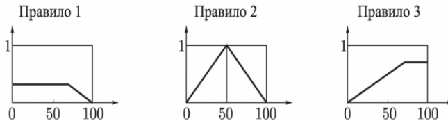
Рис. 22. Графики функций \gamma_1^1(y) , \gamma_1^2(y) , \gamma_1^3(y) выходной лингвистической переменной \omega_1 «давление»
