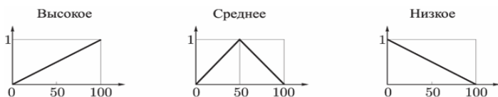
Рис. 21. Графики функций принадлежности термов выходной лингвистической переменной \omega_1 – «давление».
