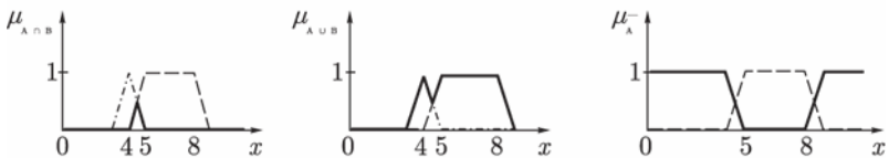
Рис. 5. Графики функций принадлежности пересечения множеств A и B , объединения множеств A и B , дополнения множества B
