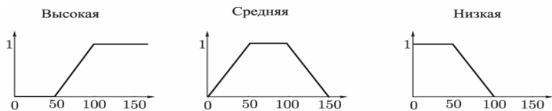
Рис. 19. Графики функций принадлежности термов входной лингвистической переменной \beta_1 – «температура»
