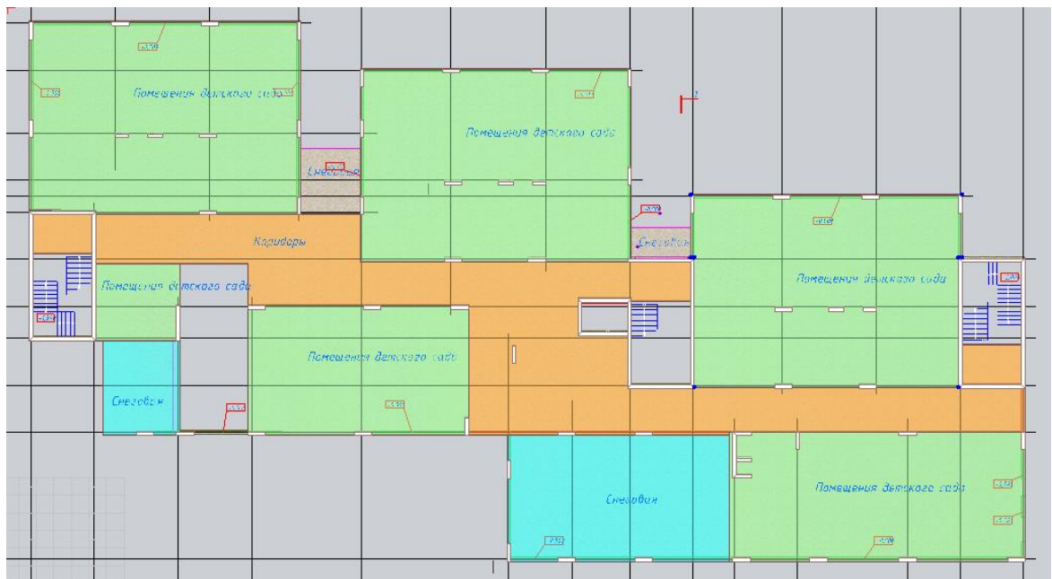
Рисунок Б.2 – Схема расположения нагрузок от помещений разного функционального назначения на плите перекрытия
