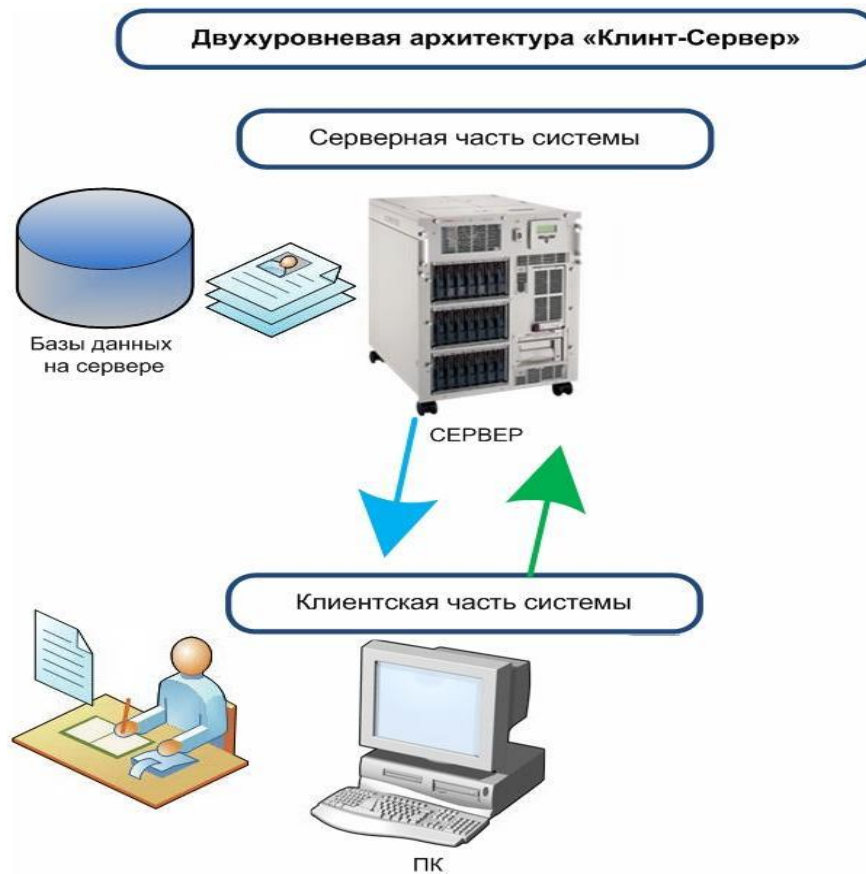
Рисунок 17 – Двухуровневая архитектура разрабатываемого проекта
