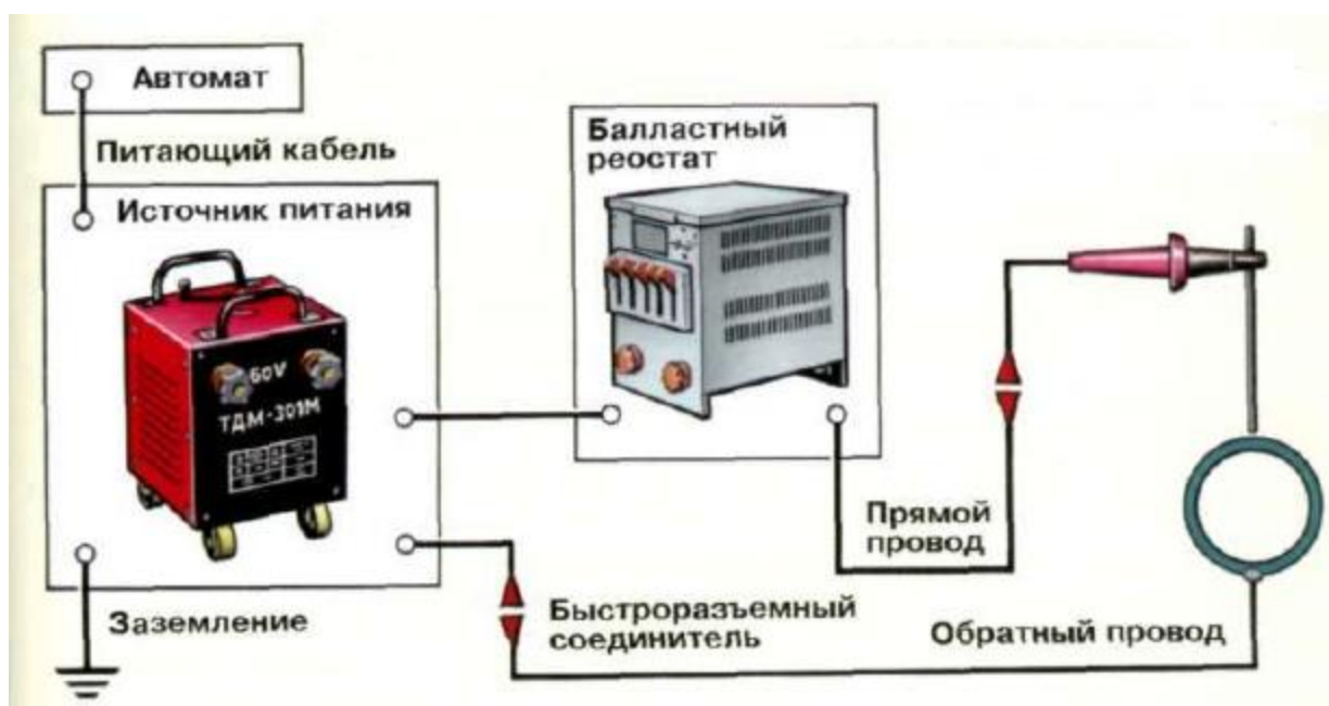
Рисунок 3 – Схема выполнения ручной дуговой сварки штучными электродами
