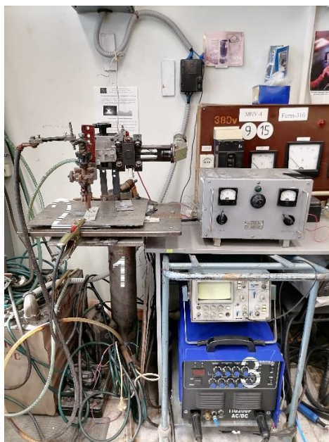
1-стенд, 2-горелка, 3- инвертор
