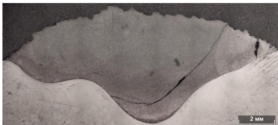
Рисунок 50 – Макроструктура наплавки образца № 6
