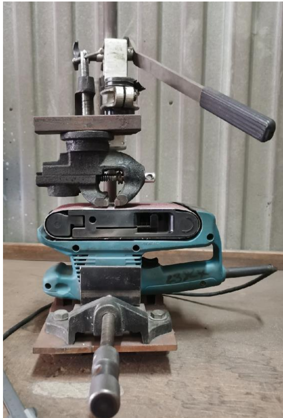
Рисунок 21 – Установка для испытания на износостойкость наплавленных образцов на износостойкость УХ-11
