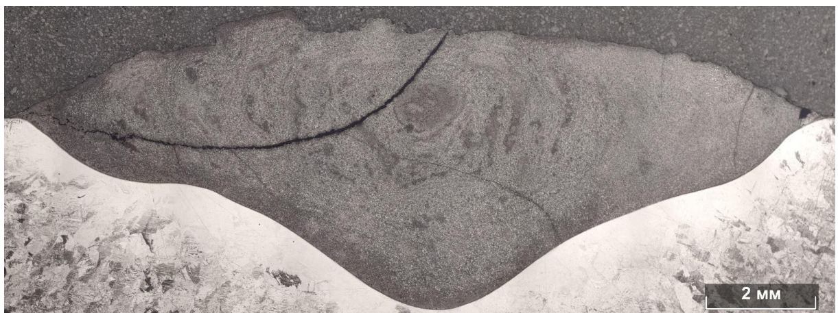
Рисунок 47 – Макроструктура наплавки образца № 5
