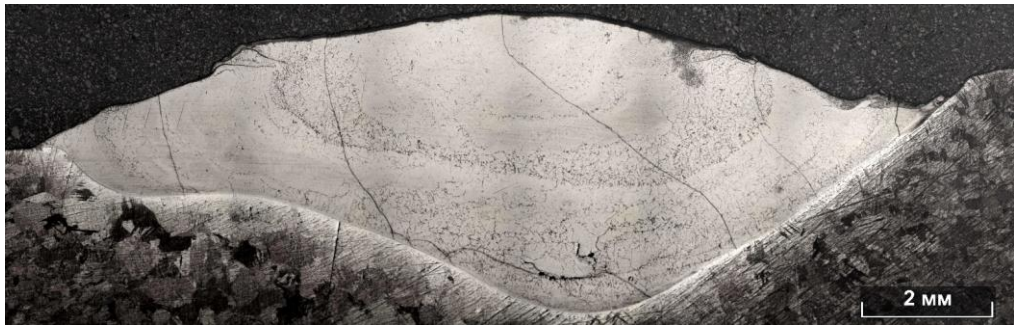
Рисунок 53 – Макроструктура наплавки образца № 2-1
