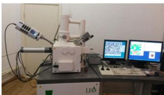
Рисунок 17 – Сканирующий электронный микроскоп LEO 1455 VP
