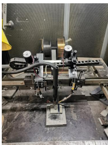
Рисунок 14 – Установка для автоматической аргодуговой наплавки неплавящимся электродом с подачей двух присадочных проволок УК-2
