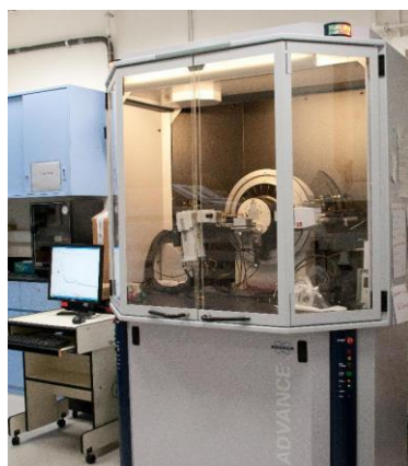
Рисунок 19 - Рентгенофазовый дифрактометр Bruker D8 Advance Eco (Bruker AXS GmbH)
