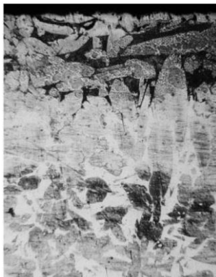
Рисунок 9 – Микроструктура покрытия на поверхности латуни ЛМцЖ-55-3-1,5
