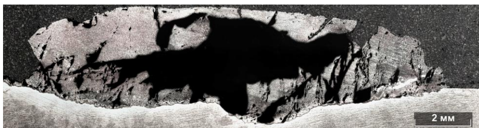
Рисунок 70 – Макроструктура наплавки образца 2-6
