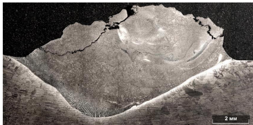
Рисунок 62 – Макроструктура наплавки образца № 2-4
