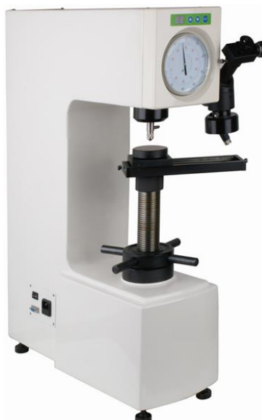
Рисунок 20 -стационарный универсальный твердомер HBRV-187.5
