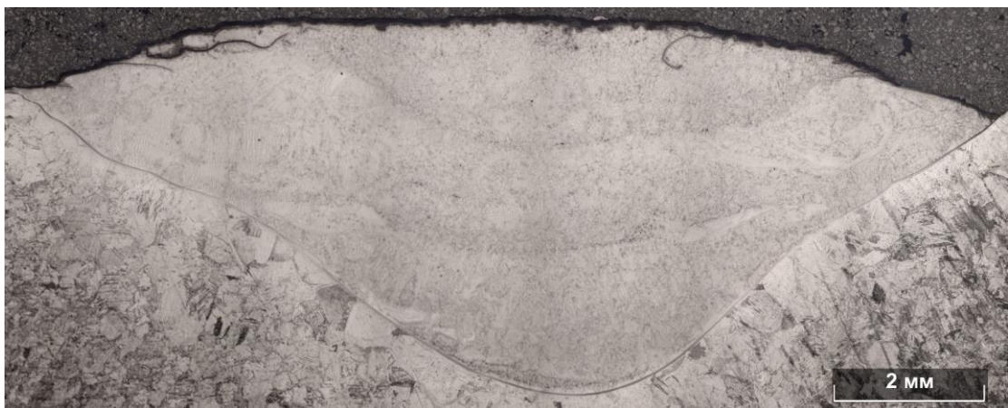
Рисунок 44 – Макроструктура наплавки образца № 4
