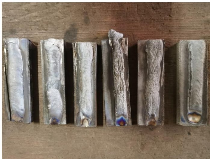
Рисунок 23 – Образцы наплавленных валиков
