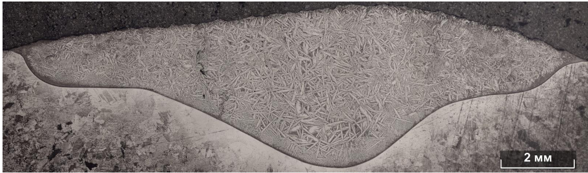
Рисунок 38 – Макроструктура наплавки образца № 2
