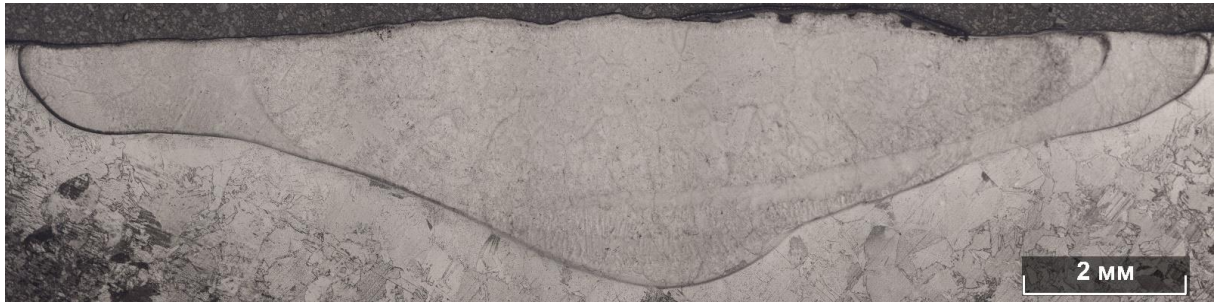
Рисунок 35 – Макроструктура наплавки образца № 1
