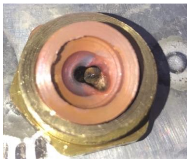
Рисунок 12 – Результат возникновения двойной дуги
