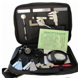
Рисунок 9 – Оборудование для проведения визуально-измерительного контроля
