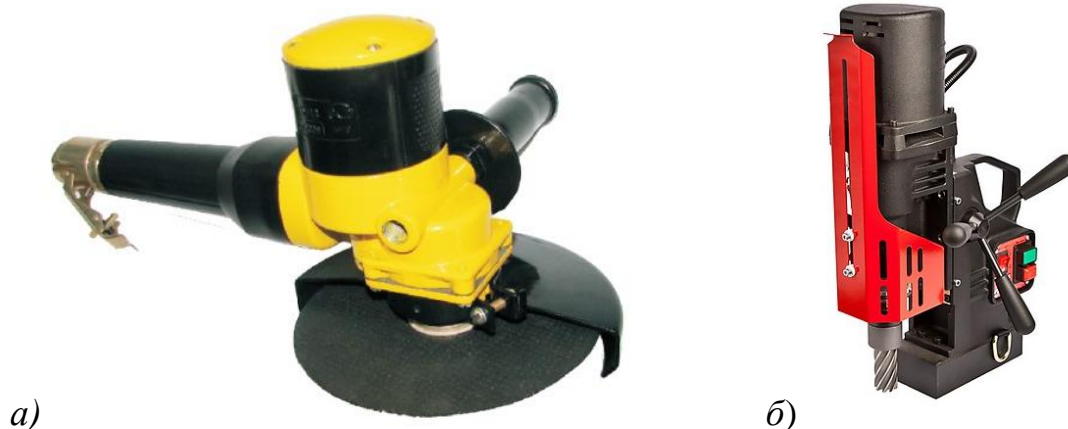
Рисунок 6 – Оборудование для подготовки трещины под заварку: угловая шлифовальная машина ИЭ-2106 (а) и сверлильный станок на магнитном основании МС-36 (б)
