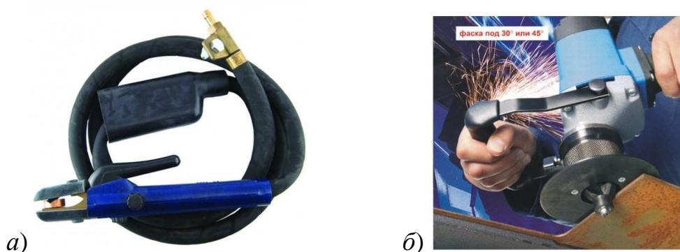
Рисунок 7 – Оборудование для разделки трещины: горелка для воздушно-дуговой строжки (а) и кромкофрезеровальная машина ЕКФ-300
