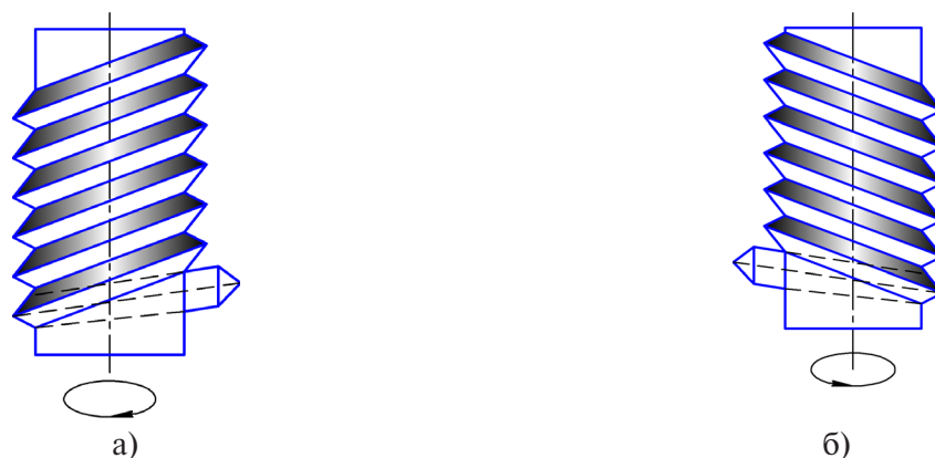
Рис. 3. Резьба треугольного профиля: а – правая; б – левая
