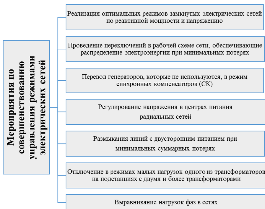
Рисунок 9 – Мероприятия по усовершенствованию управления режимами сетей согласно комплексной программе снижения потерь в ООО «Газпром трансгаз Югорск»
