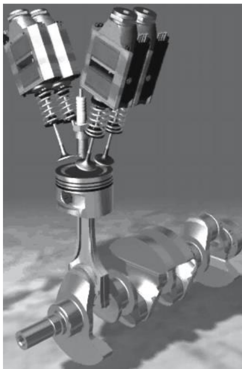
Рисунок 12 – Управление электромагнитным клапаном
