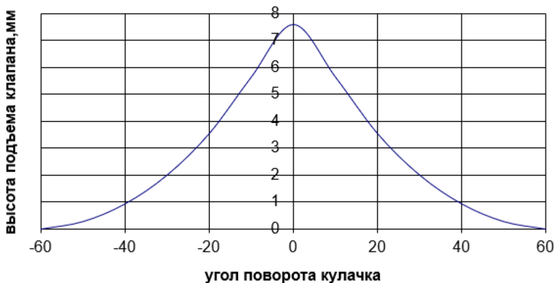
Рисунок 36 – Диаграмма подъема впускного клапана базового двигателя
