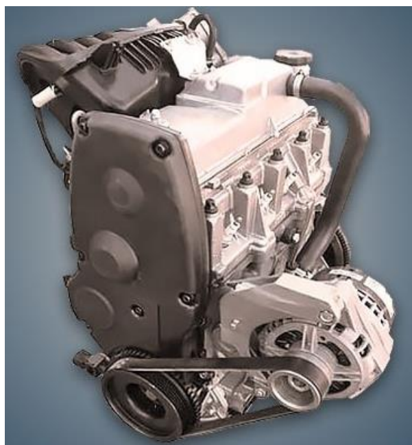
Рисунок 13 – Общий вид двигателя ВАЗ-11186, взятого как базовый для расчета
