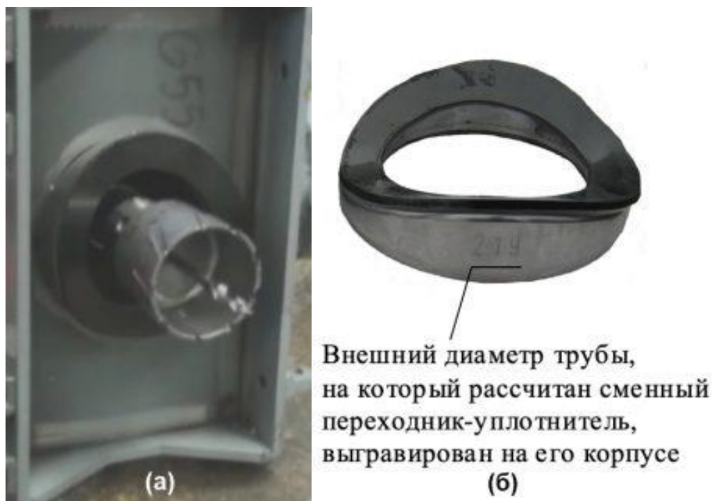
Рисунок 5 – Сменный переходник-уплотнитель: (а) – внутри банджа; (б) – отдельно, с гравировкой внешнего диаметра трубы.
