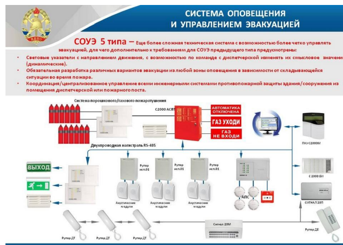
Рисунок 6 – Пятый тип системы оповещения и управлением эвакуацией, установленный на основании СП 3.13130.2009
