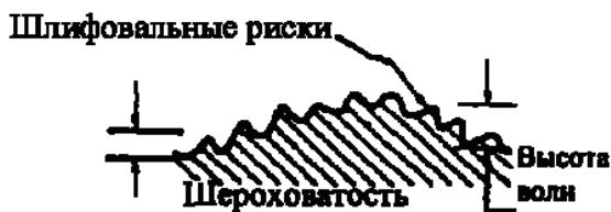
Рис. 2.3.6. Схематическое изображение участка волнистой поверхности детали после шлифования в разрезе
