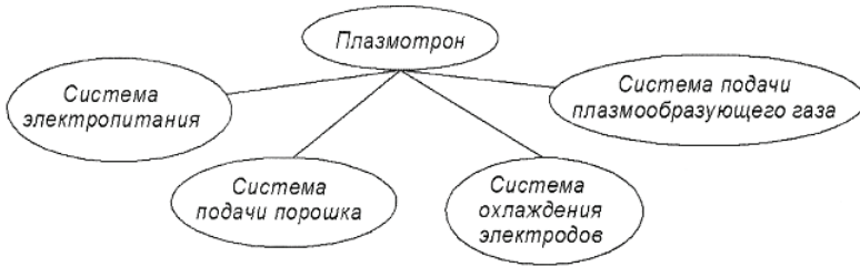
Рис. 1.1.16. Структурная схема систем питания плазмотрона
