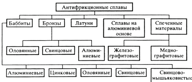
Рис. 2.2.14. Классификация антифрикционных сплавов
