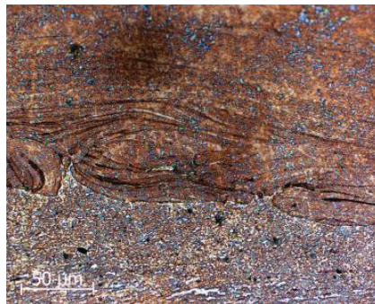
Рис. 2.3.14. Массоперенос в поверхностном слое при трении
