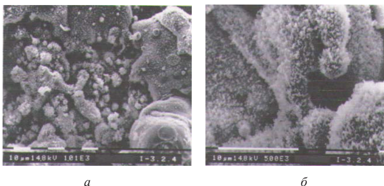
Рис. 1.2.19. Поверхность имплантата с плазмонапыленным гидроксипатитом на пористом титановом подслое при L = 110 мм, \Delta < 70 мкм
