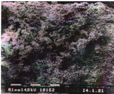
Рис. 1.2.18. Поверхность имплантата с плазмонапыленным гидроксиапатитом на пористом титановом подслое при L = 110 мм, \Delta > 100 мкм
