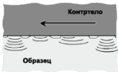
Рис. 2.3.10. Генерация упругих колебаний при трении
