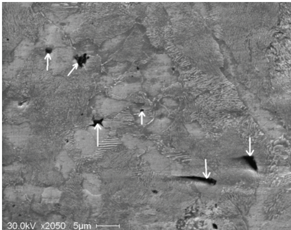
Рис. 2.2.6. Объемные дефекты (поры)
