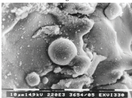
Рис. 1.1.13. Микроструктура плазмонанпыленных покрытий из титана ( a ), гидроксиапатита ( б ), никеля ( в )
