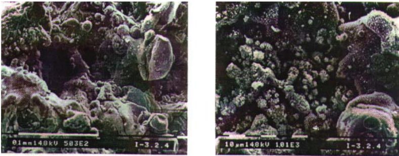
a б Рис. 1.2.15. Поверхность имплантата с плазмонанпыленным титановым покрытием при L=100 мм, \Delta > 100 мкм
