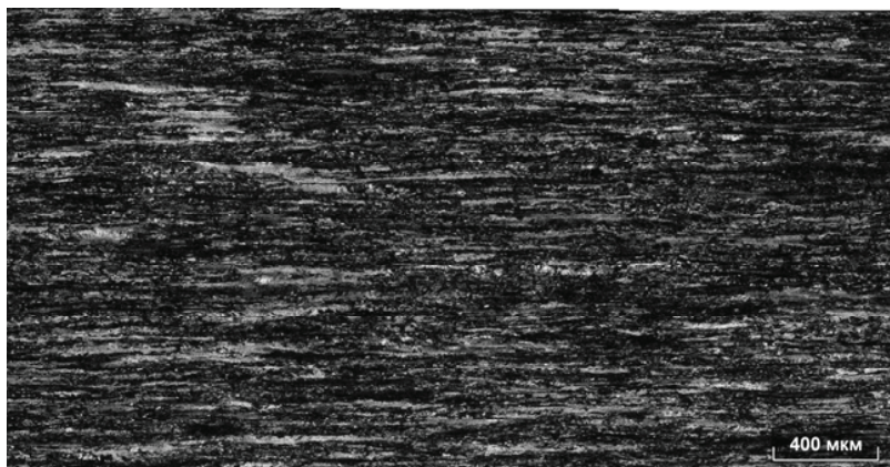
Рис. 4.9. Панорамное изображение структуры после цветного травления при увеличении \times 100 в светлом поле ( a ) и в поляризованном свете ( б )
