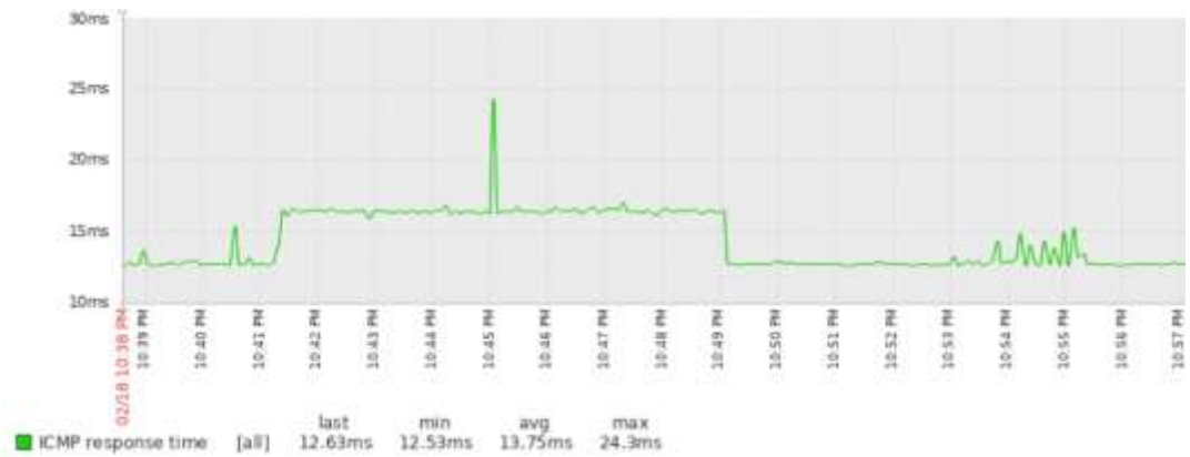
Рисунок 26 - График времени ответа на ICMP запрос во время переключения после изменения логики работы.
