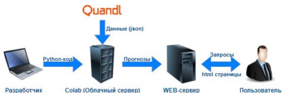
Рисунок 18 – Архитектура веб-сервиса для прогнозирования временных рядов
