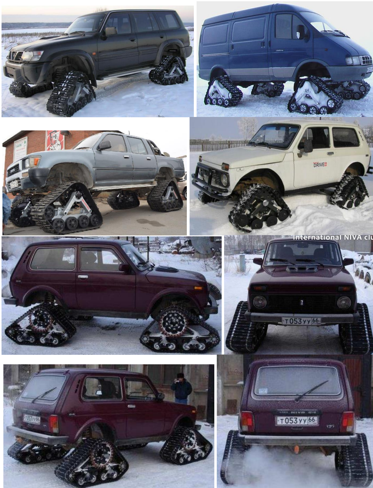
Рисунок 22 – Установка гусеничных движителей на различные модели серийных автомобилей
