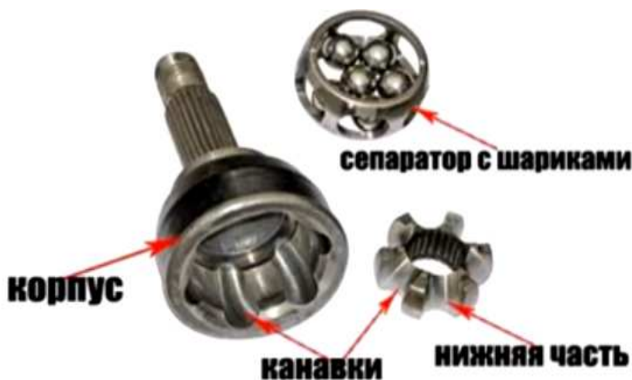
Рисунок 9 – Шариковый шарнир – составные детали
