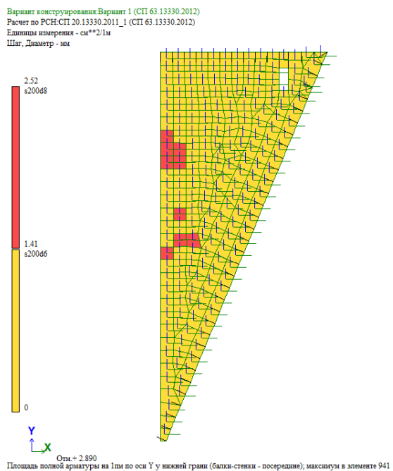
Рисунок 10 – Армирование нижней зоны монолитного участка по оси Y
